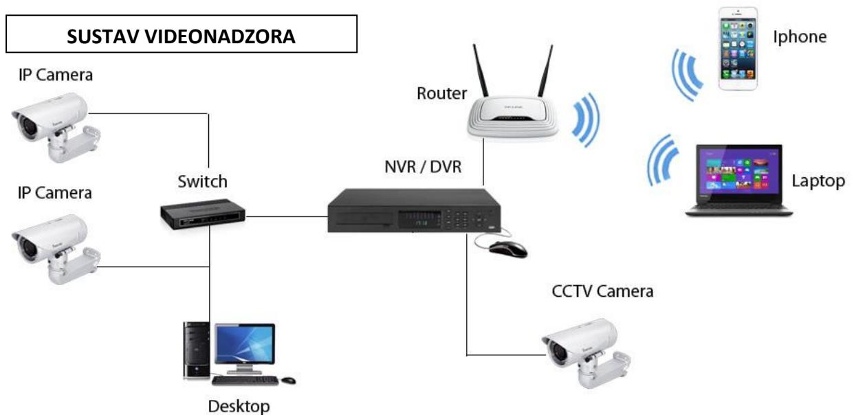
Slika 6. Predodžba sustava video nadzora: Izvor <https://svezavideonadzor.rs/video-nadzor-sve-sto-treba-da-znate/>
