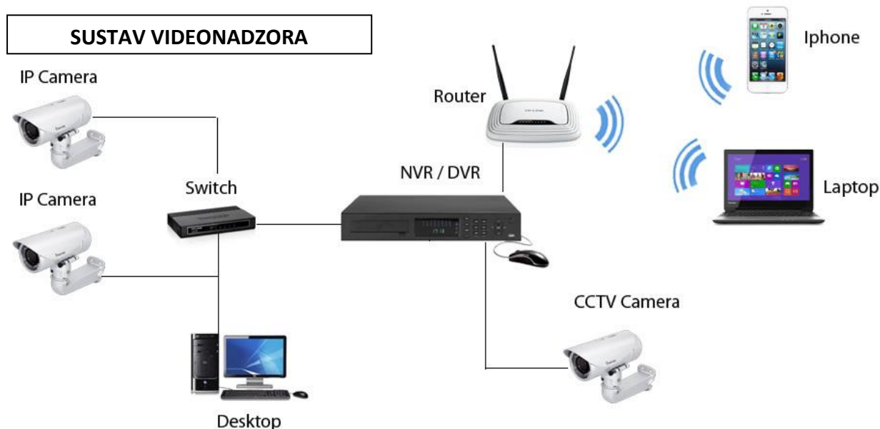
Slika 6. Predodžba sustava video nadzora: Izvor https://svezavideonadzor.rs/video-nadzor-sve-sto-treba-da-znate/
