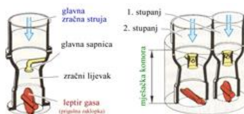
Slika 22. Jednostavni i registarski karburator
