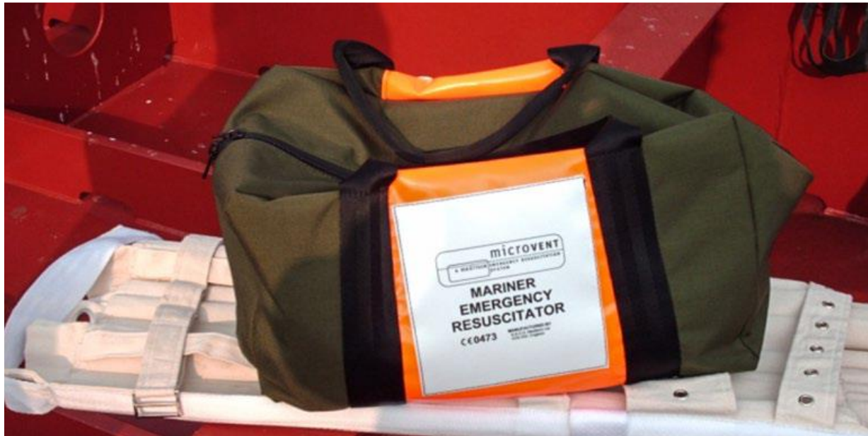
Slika 6. Hitna oprema postavljena na ulazu u zatvoreni prostor
