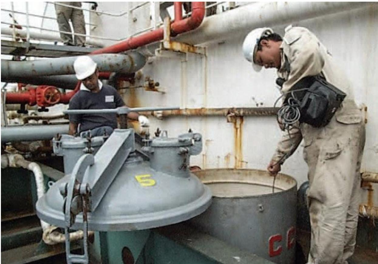
Slika 5. Ispitivanje atmosfere zatvorenog prostora
