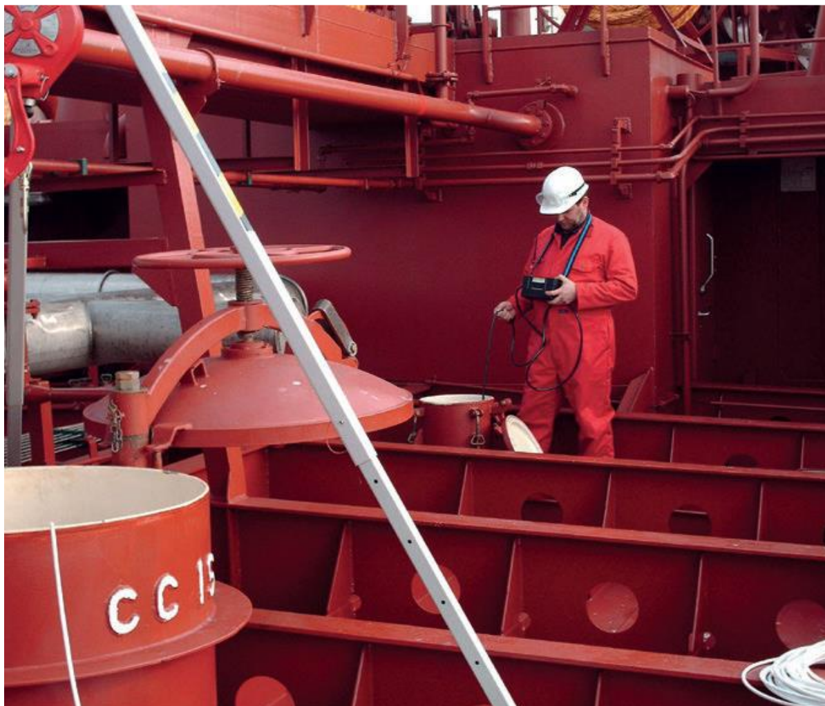
Slika 7. Redoviti testovi atmosfere uzimaju se radi praćenja okoline u zatvorenom prostoru
