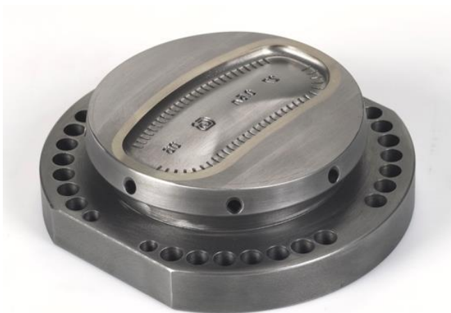
Sl.61. Dno kalupa – mat. SIVI LIJEV
