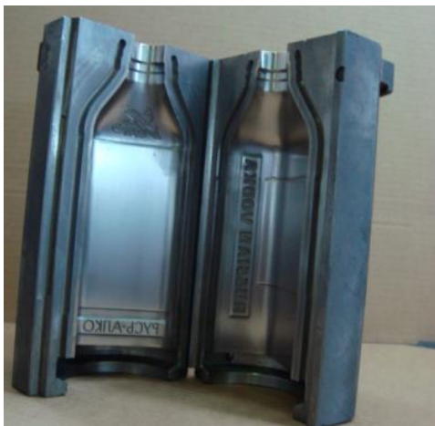
Slika 12 .a) Kalup (sivi lijev SL 25) [1]
