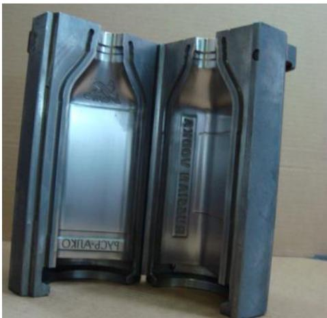
Slika 12 .a) Kalup (sivi lijev SL 25) [1]
