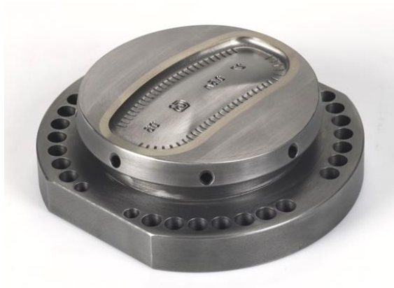
Slika 13. b) Dno kalupa (sivi lijev SL 25) [1]
