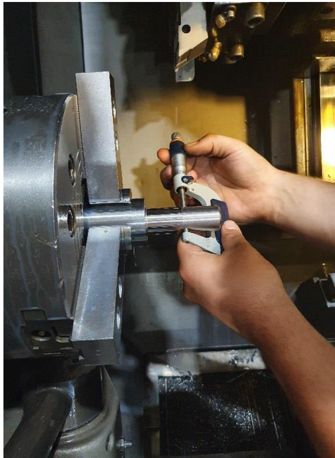
Slika 39. Kontrola dimenzija mikrometrom.
