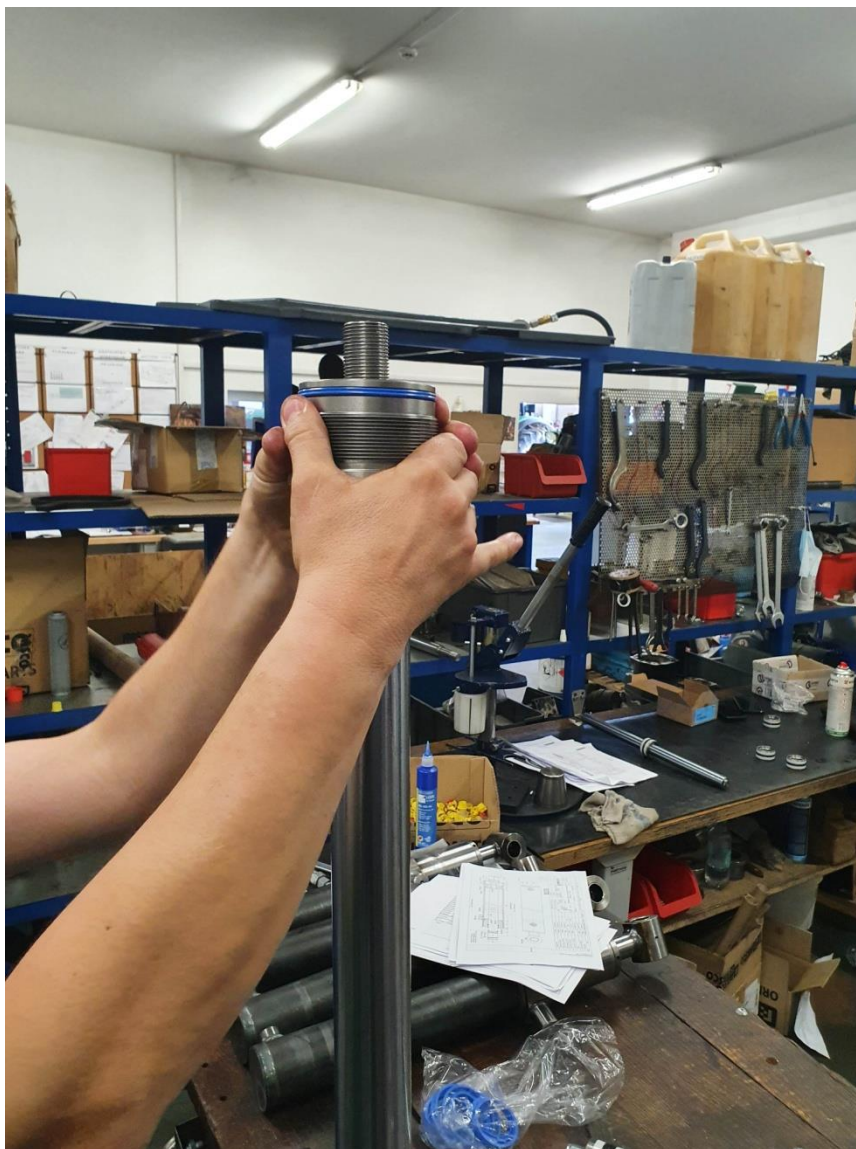
Slika 74. Montiranje usta cilindra.
