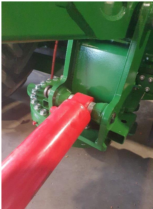
Slika 100. Montaža cilindra na ruku kranske kosilice (1).
