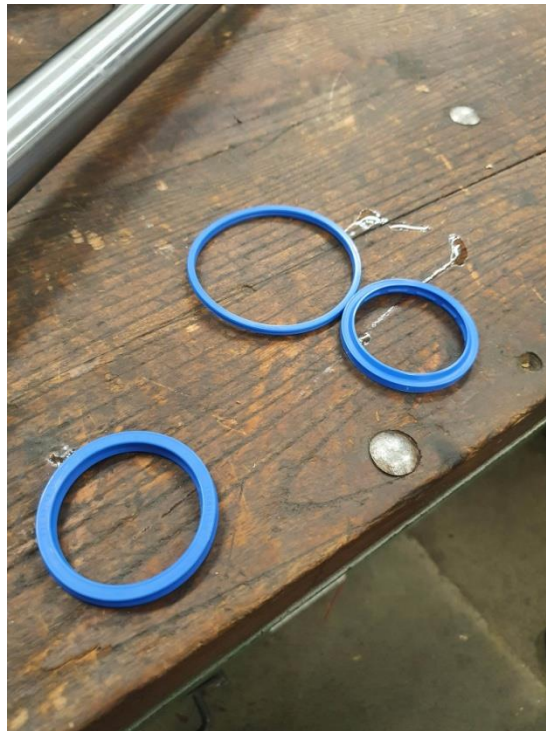
Slika 68. Brtve za usta cilindra.
