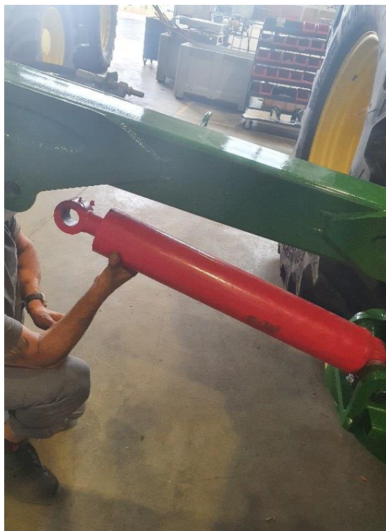
Slika 101. Montaža cilindra na ruku kranske kosilice (2).
