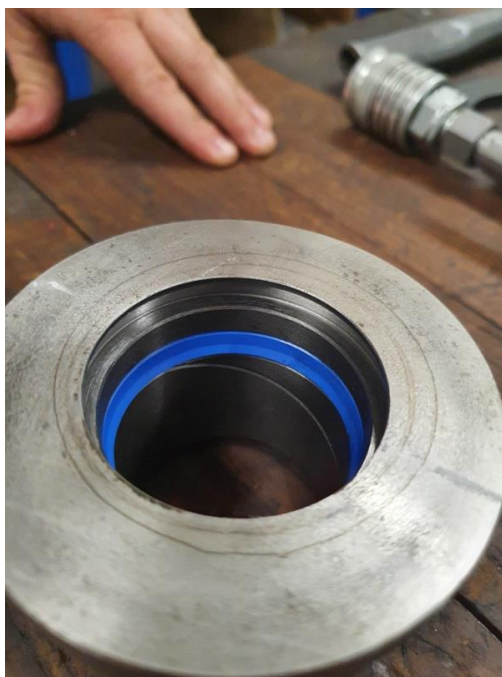
Slika 69. Montiranje unutarnje brtve.
