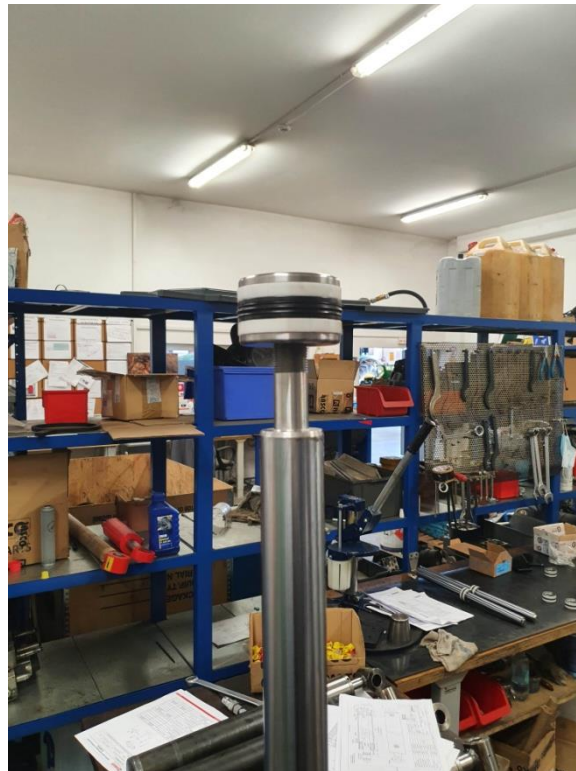
Slika 76. Montaža klipa na klipnjaču.
