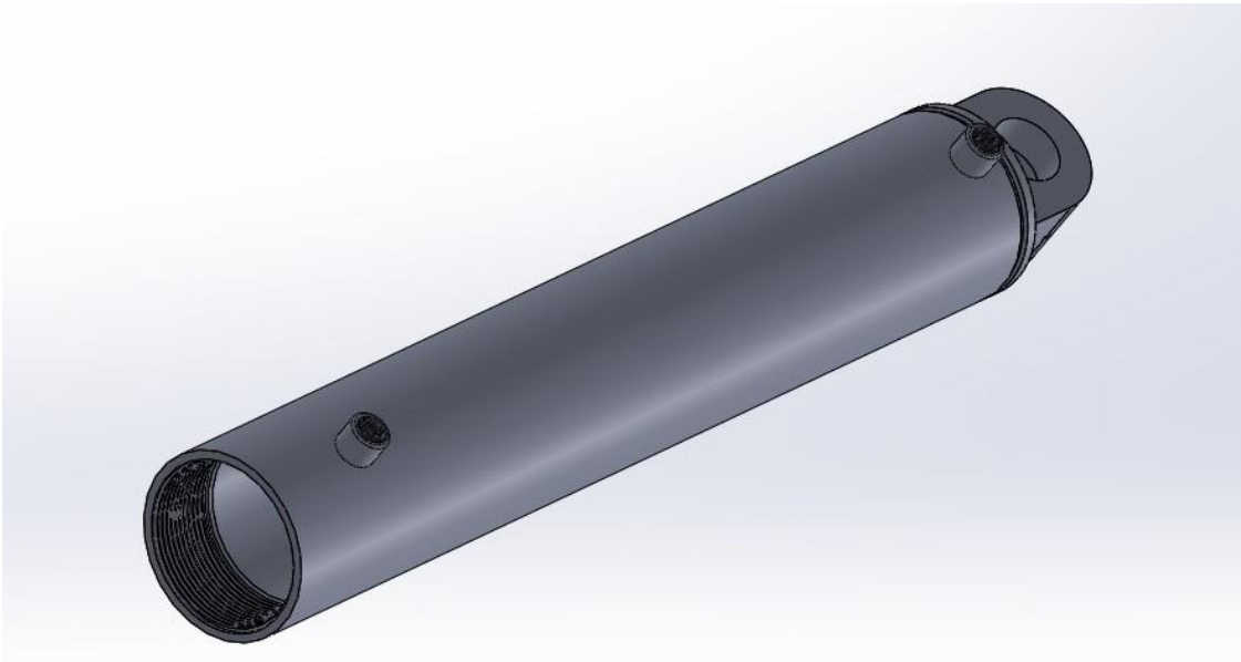
Slika 26. 3D računalni model sklopa cijevi cilindra.
