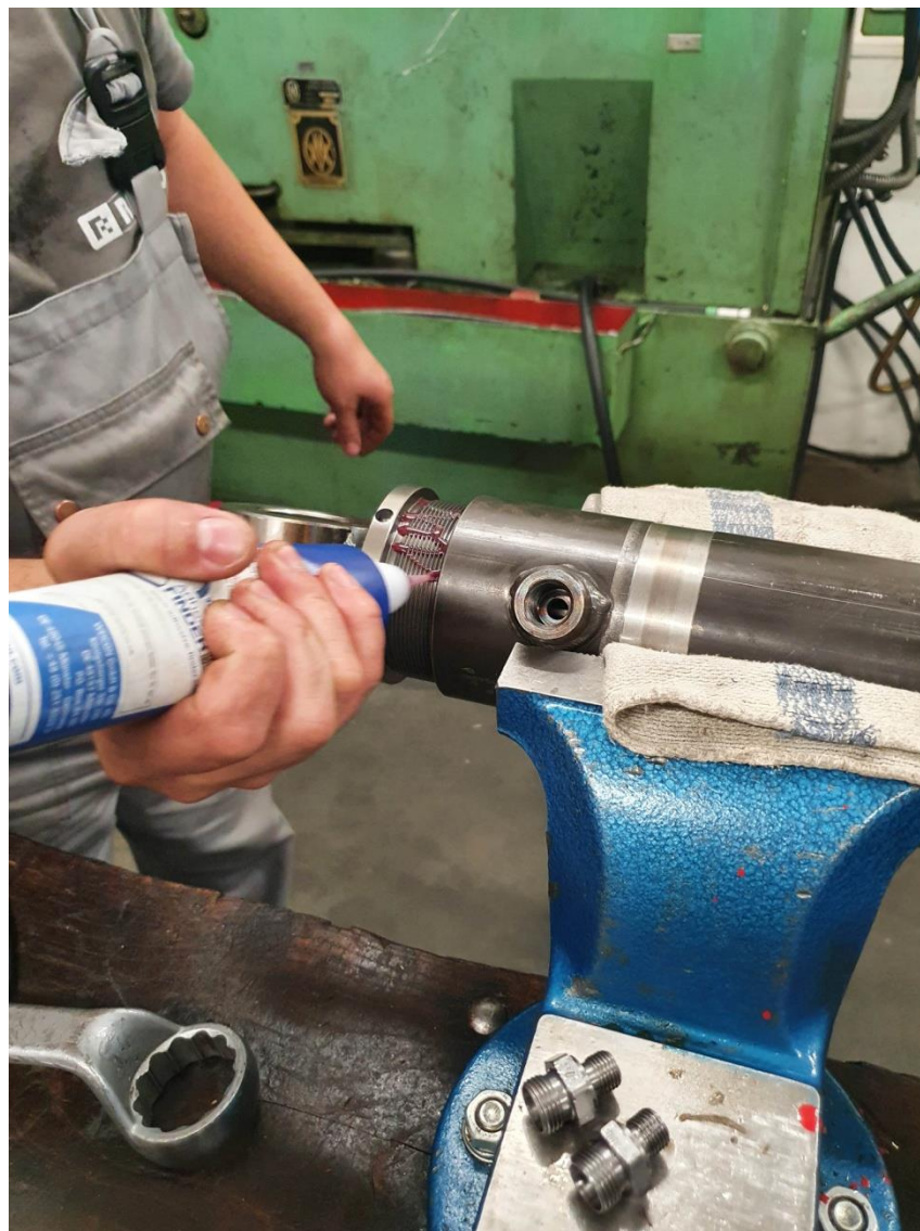
Slika 85. Nanošenje ljepila na navoj usta cilindra
