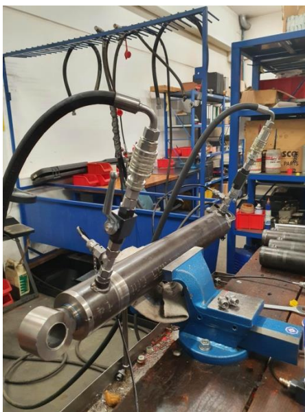
Slika 91. Priključnice spojene na cilindar.
