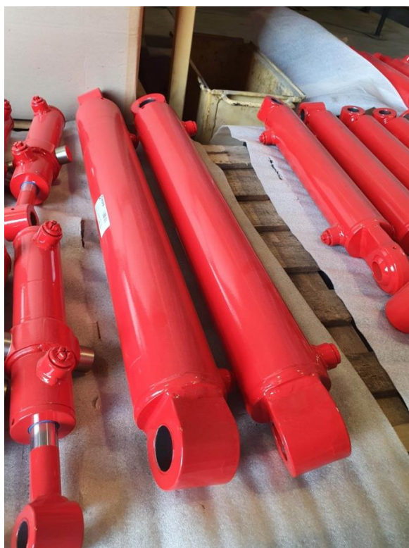
Slika 99. Cilindar nakon bojanja.
