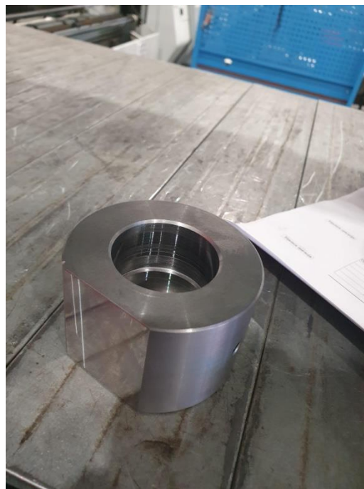
Slika 48. Izgled oka klipnjače nakon glodanja.
