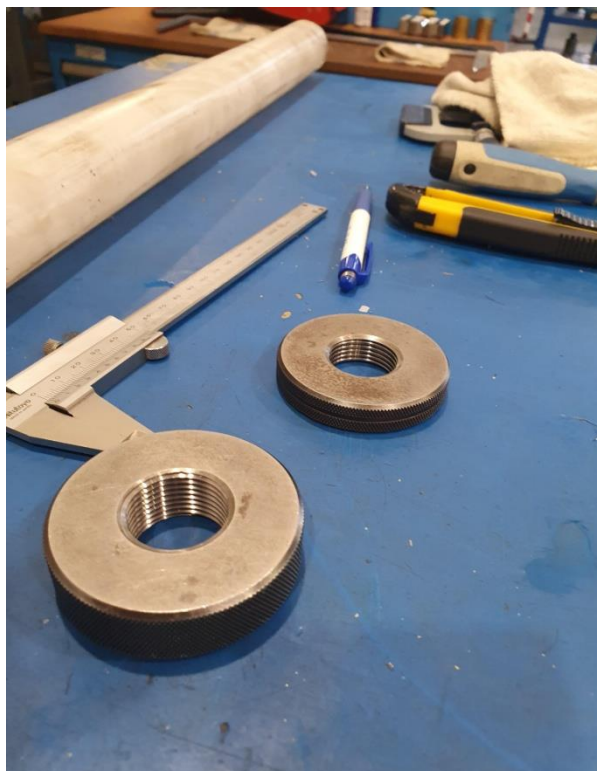
Slika 41. Provjera debljine navoja.
