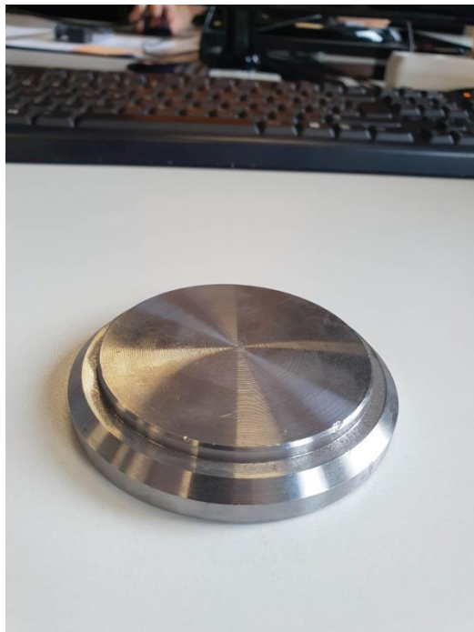
Slika 54. Poklopac cilindra \varnothing 100 / \varnothing 115 .
