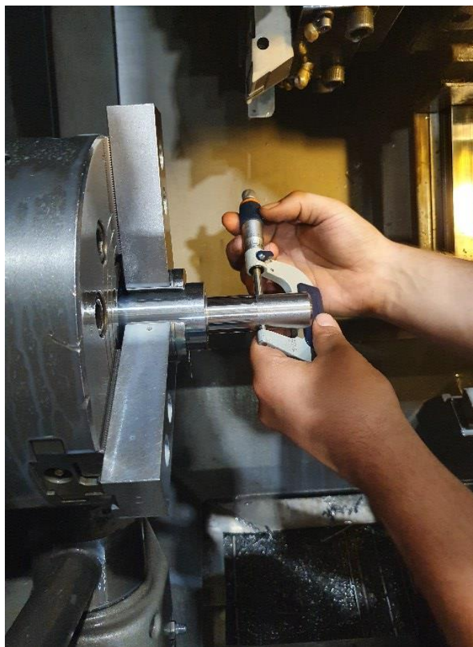
Slika 39. Kontrola dimenzija mikrometrom.
