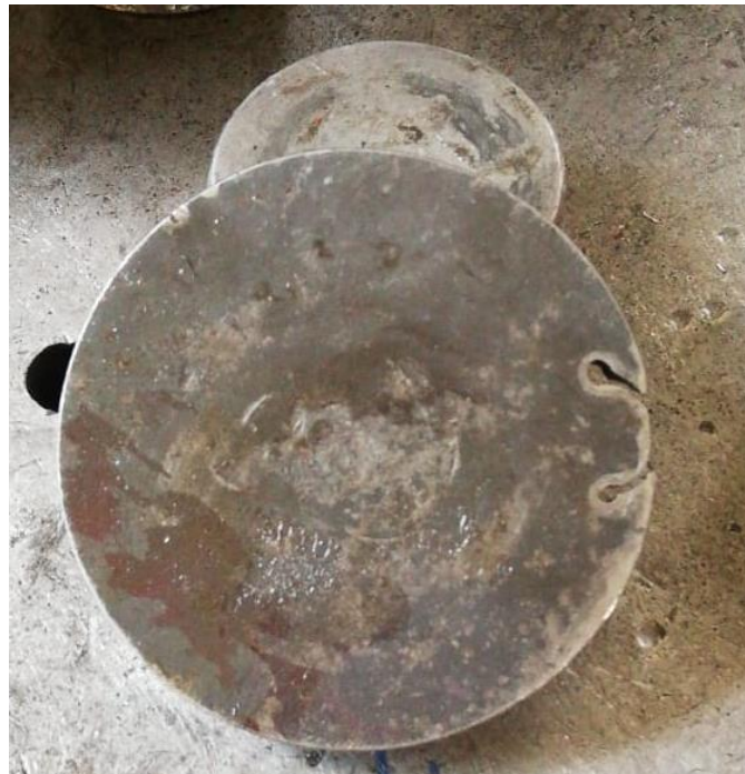
Slika 54. Naprava za uprešavanje zupčanika sa unutarnjim ozubljenjem
