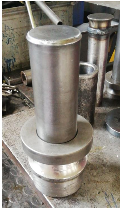
Slika 52. Naprava za uprešavanje klizne čahure na zupčanik s unutarnjim ozubljenjem
