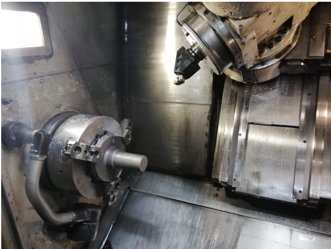
Slika 42. prikaz stezanja obratka u steznu glavu
