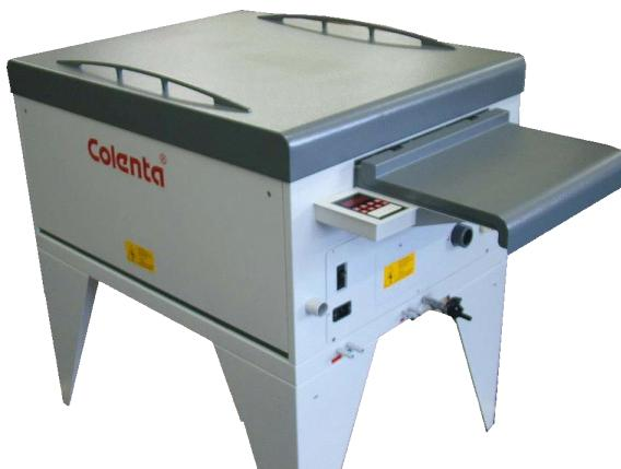
Slika 29: Uređaj za razvijanje radioloških snimki iz rtg filmova
