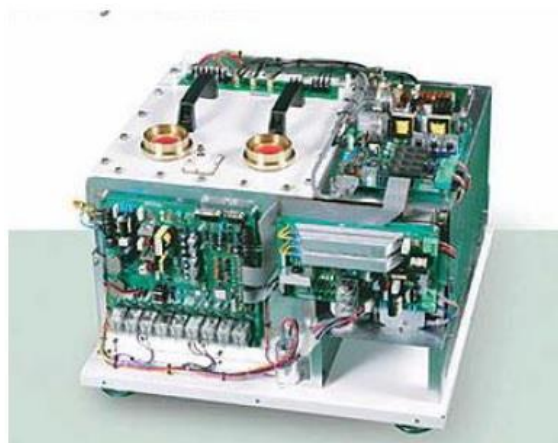
Slika 15: Generator rendgenskog uređaja
