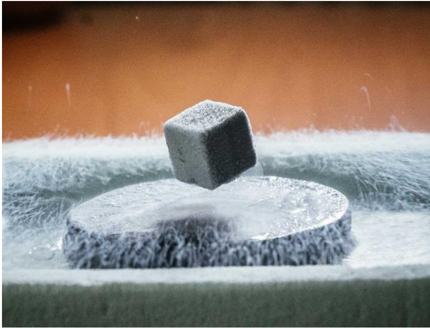
Sl. 4 Magnetska levitacija visokotemperaturnog supravodiča [8]
