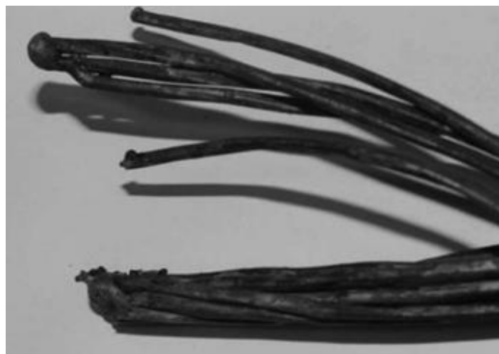
Slika 13: Kuglice na vrhu vodiča
