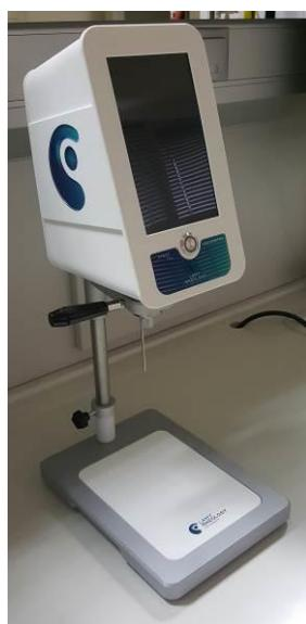
**Slika 4.** Rotacijski viskozimetar Lamy Rheology.
