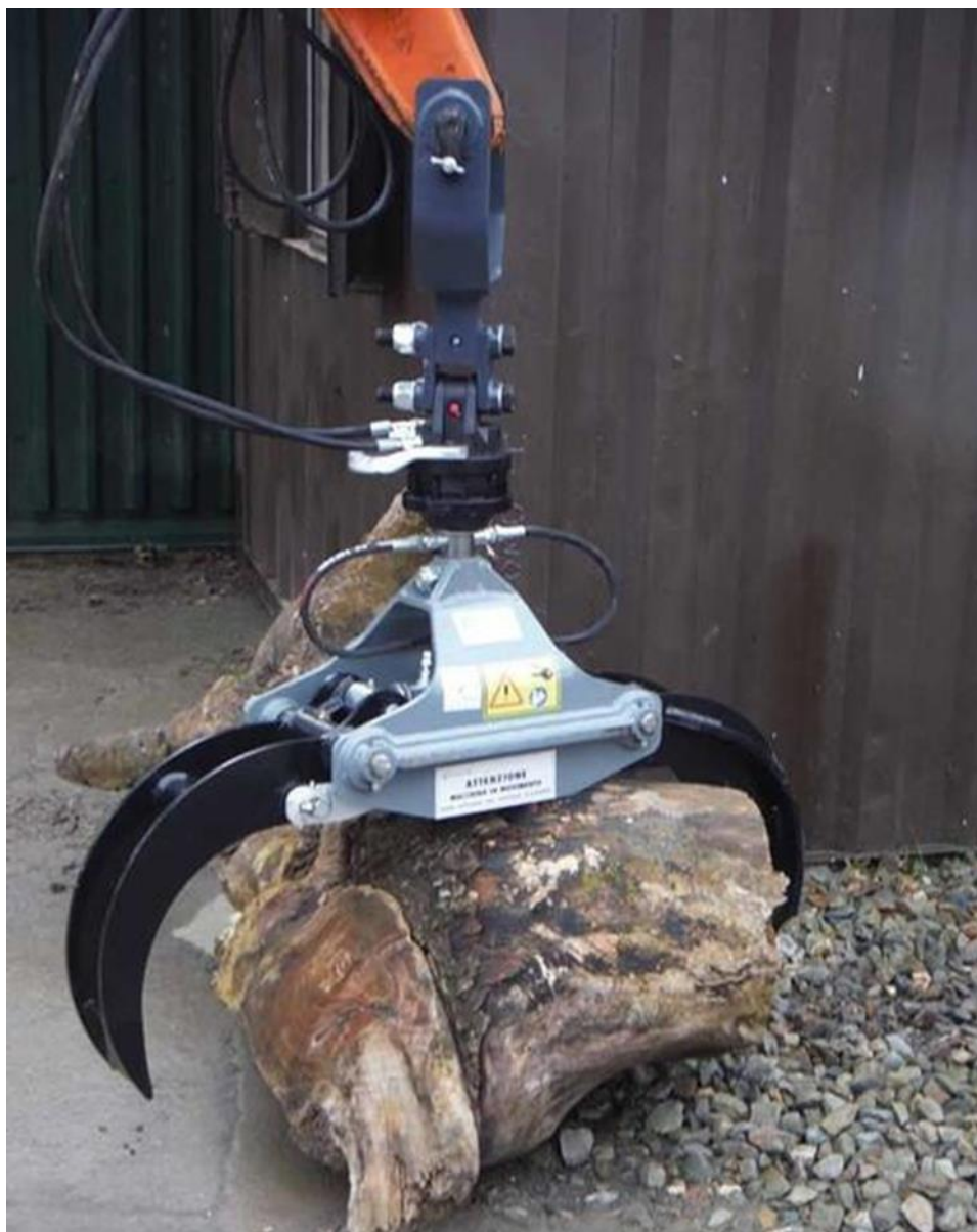
Slika 2. 1. Hidrauličke škare za trupce s rotatorom. [6]
