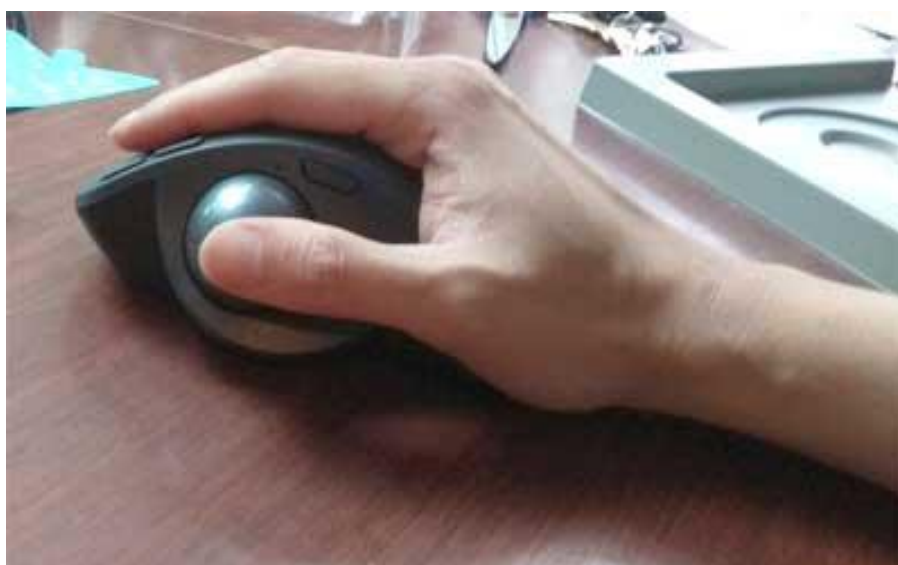
Slika 21: Trackball kojim se upravlja palcem [11]
