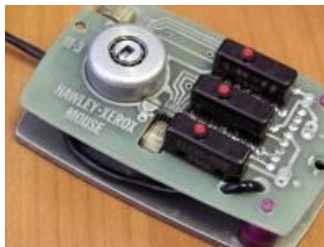
Slika 9: Prikaz unutarnjeg djela Xerox Alto računalnog miša [6]
