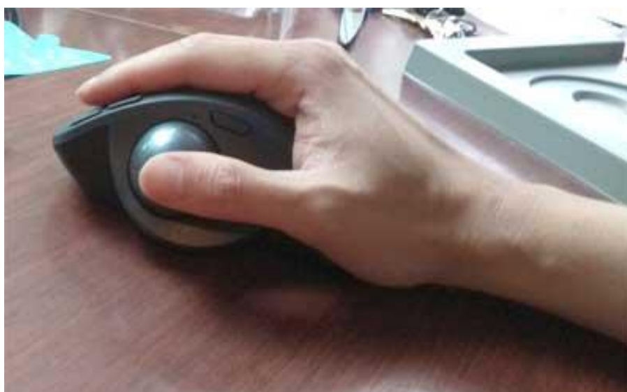
Slika 21: Trackball kojim se upravlja palcem [11]
