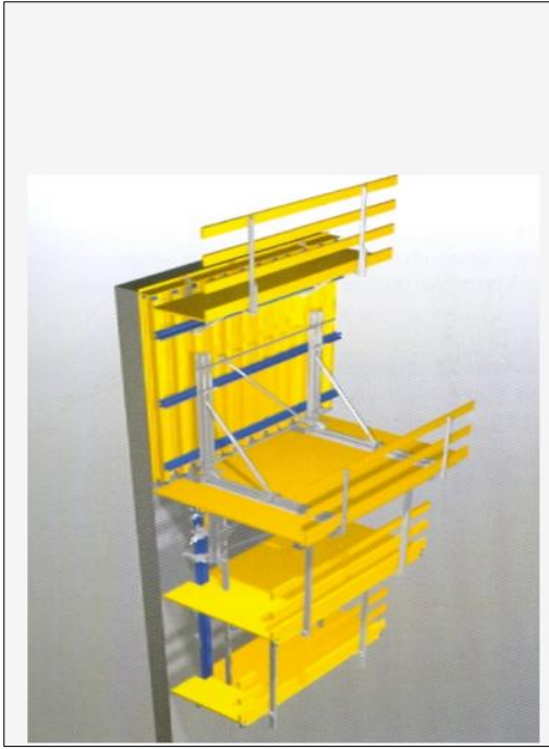
Slika 21. Završen je takt betoniranja
