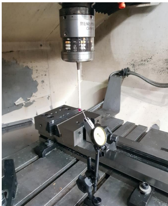
Slika 32. Postavljanje mjerne ure – komparatora u odnosu kontaktno ticalo 3D mjerne glave
