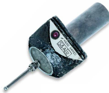
Slika 8. Prva mjerna glava s kontaktnim ticalom [16]
