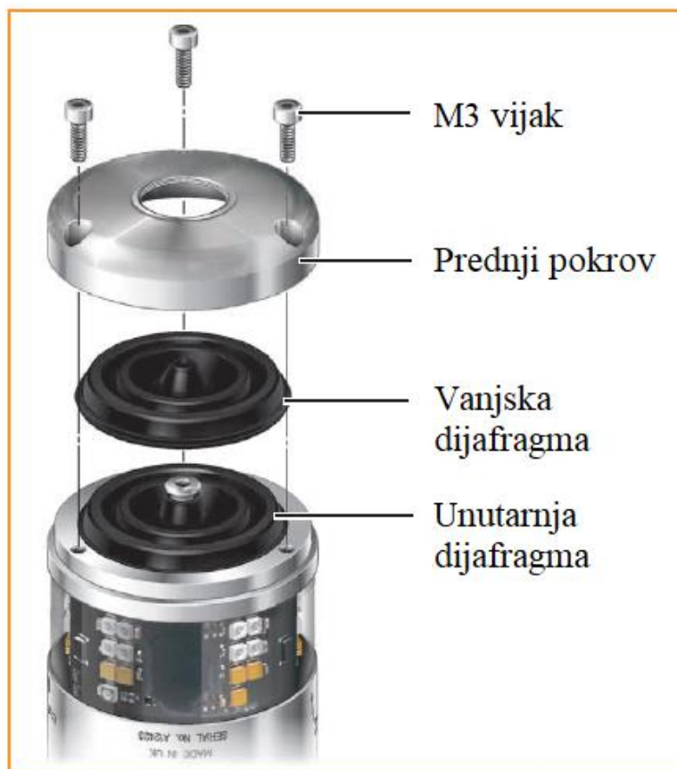
Slika 27. Pregleda stanja, odnosno vidljivih znakova oštećenja, te zamjena vanjske dijafragme 3D mjernu glavu [21]
