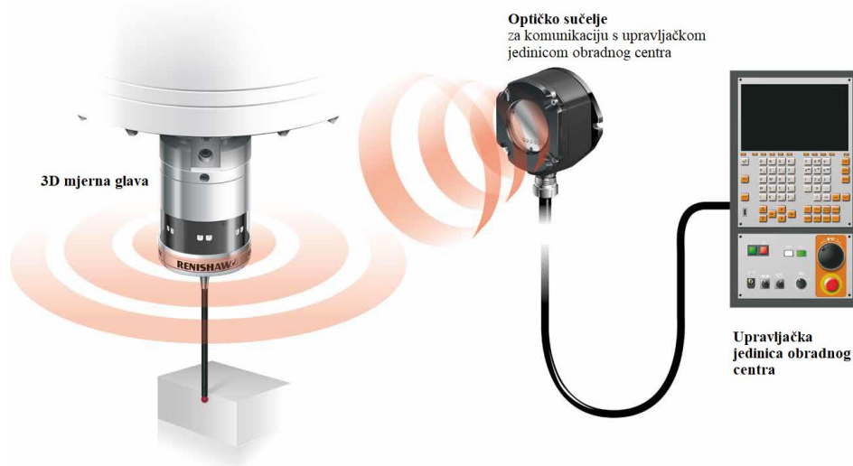
Slika 16. Optički sustav za prijenos podataka [16]
