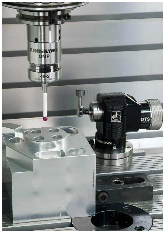
Slika 7. Sustav za mjerenje (pripremu, kontrolu, podešavanje) na obradnom centru [16]
