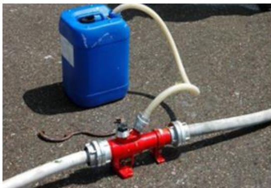
Slika 22. Međumiješalica protoka 200 l/min i Firesorb aditiv [Izvor:
