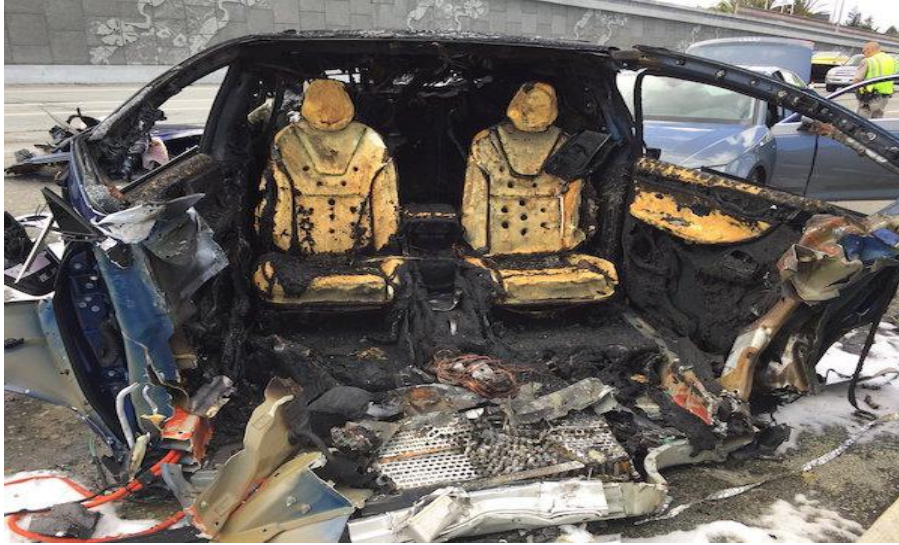
Slika 23. Požar električnog vozila [Izvor: https://www.nakedcapitalism.com/2018/04/tesla-encounters-material-world.html ]
