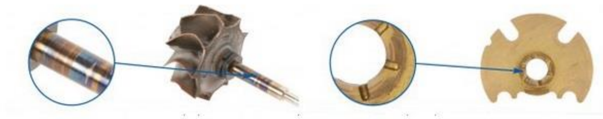
Pregrijavanje/zaribavanje uslijed manjka tlaka ulja
