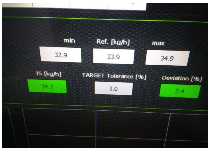
Slika 62 Podešenje protoka varijabilne geometrije [17]
