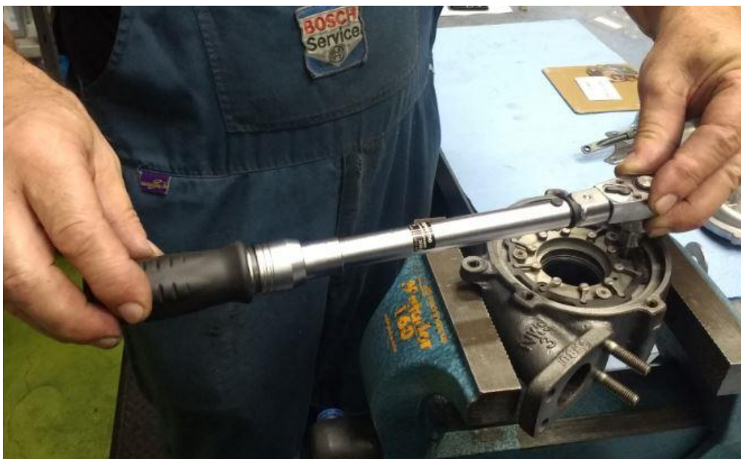
Slika 61 Pritezanje vijaka varijabilne geometrije moment ključem [17]
