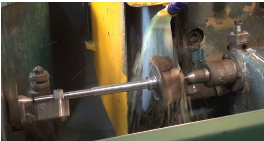
Slika 18 Brušenje turbinskog rotora [12]
