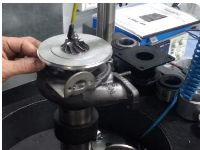
Slika 62 Podešenje protoka varijabilne geometrije [17]
