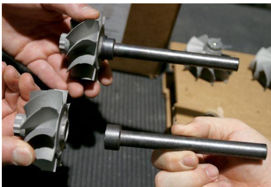
Slika 17 Turbinsko vratilo – spajanje [12]
