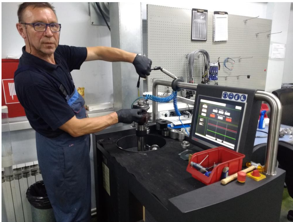
Slika 38 Mjerenje protoka varijabilne geometrije [17]
