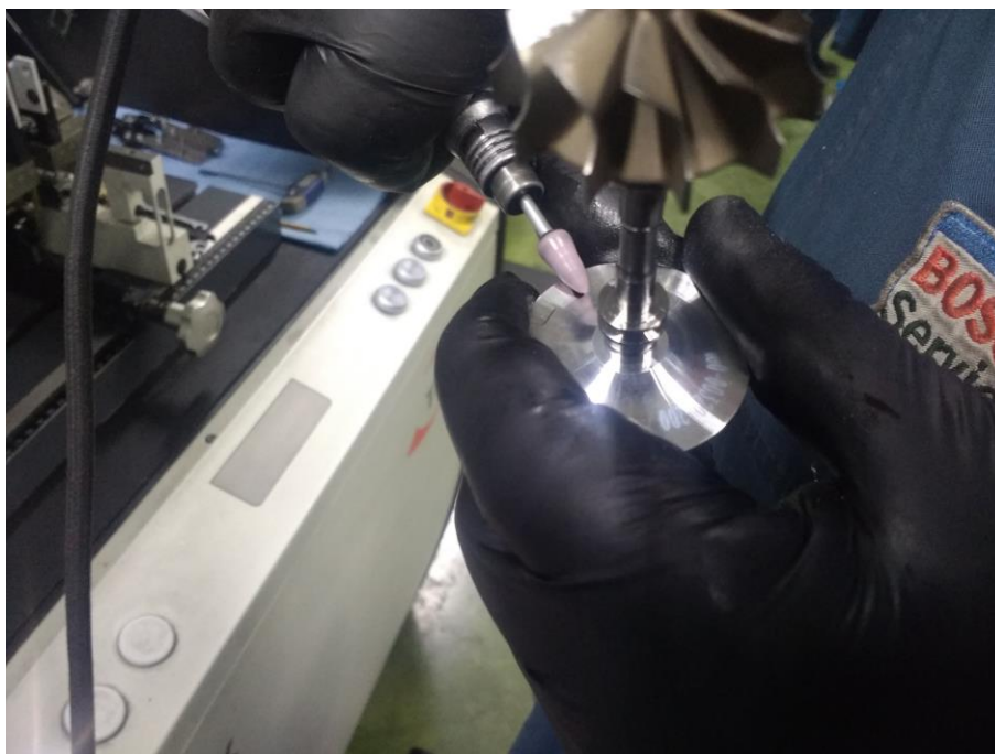
Slika 51 Uklanjanje mase - kompresijski rotor [17]
