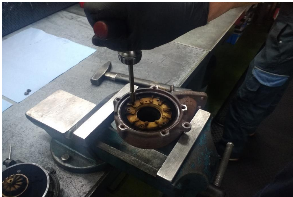
Slika 39 Rastavljanje varijabilne geometrije unutar turbinskog kućišta [17]
