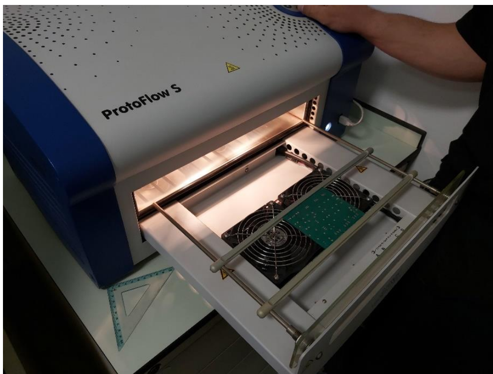
Slika 57. Položaj PCB pločice u ladici pećnice
