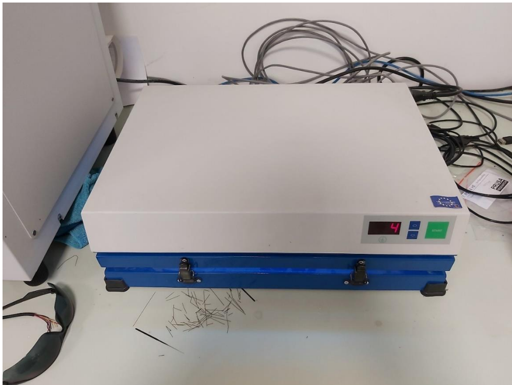
Slika 60. LPKF UV lampa
