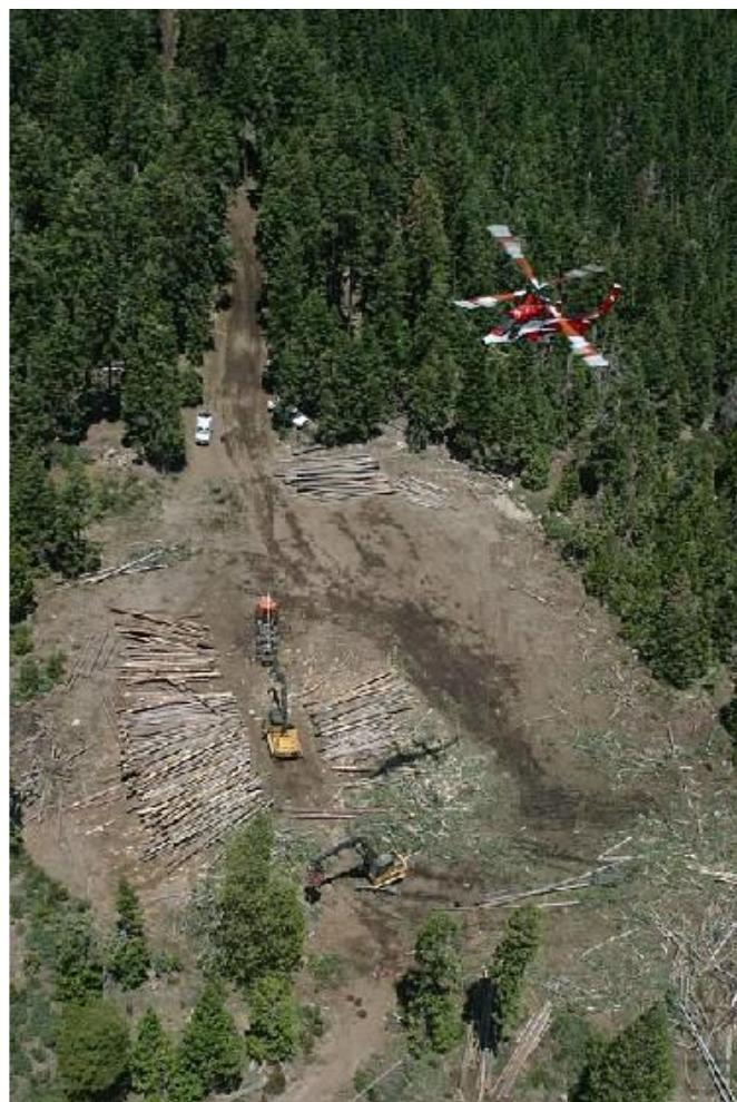
Slika 22. Stovarište/sletište pri iznošenju drva helikopterom
