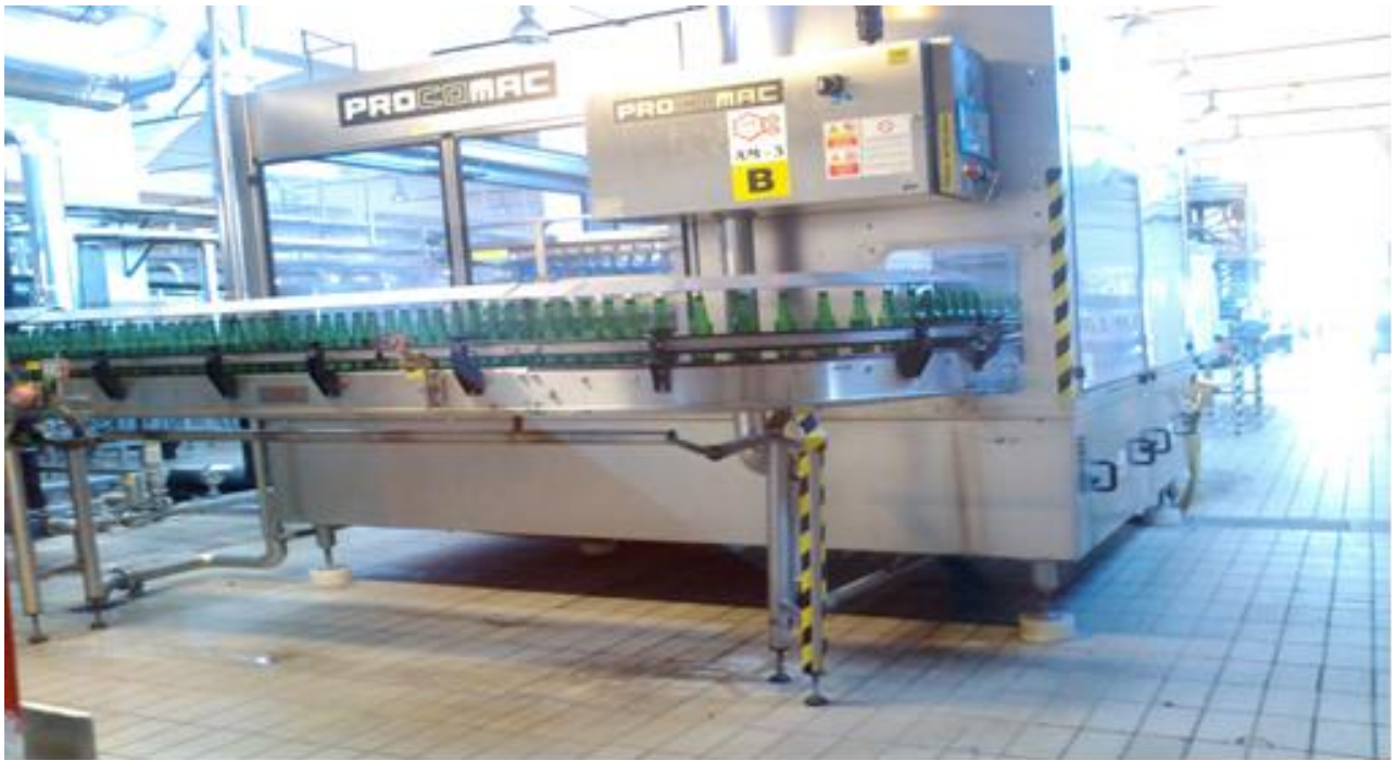
Slika 18. Stroj za ispiranje boca u pogonu
