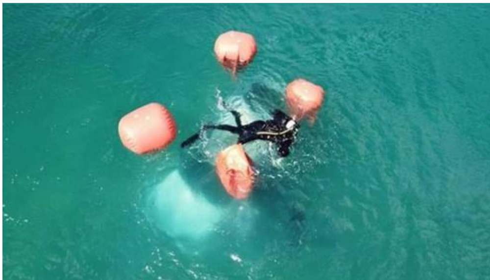
Sl. 37. Podizanje automobila sa dna ronilačkim padobranima [3]
