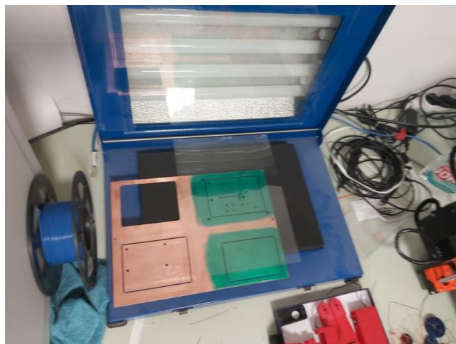
Slika 24 . Postupak osvjetljavanja UV lampom
