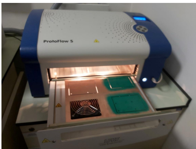
Slika 27. Postupak „pečenja“ pomoću ProtoFlow S pećnice
