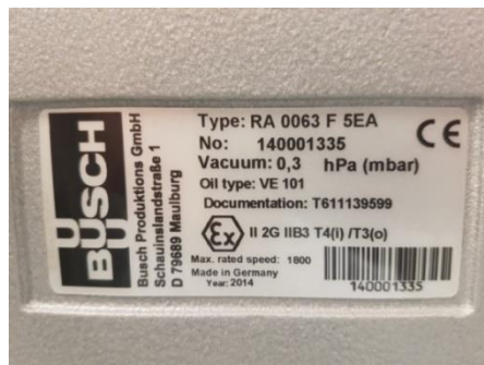
Slika 22. Oznaka vacuum pumpe koja vakumira posudu u kojoj može biti eksplozivnih para
