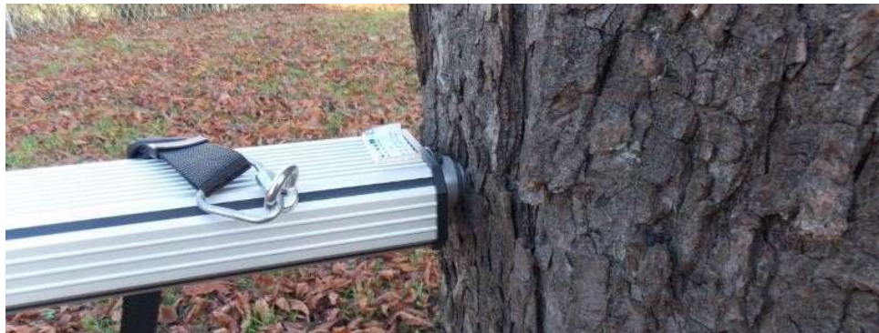
Slika br. 13 Mikro bušenje rezistografom
