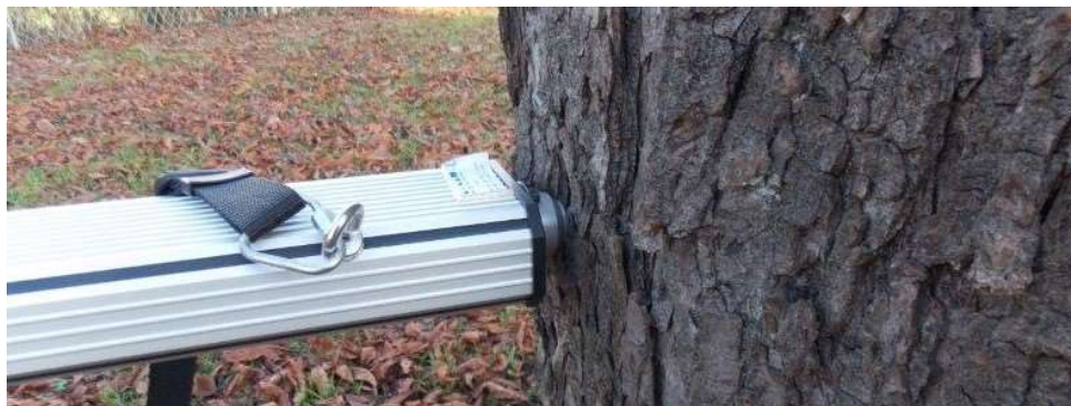
Slika br. 13 Mikro bušenje rezistografom
