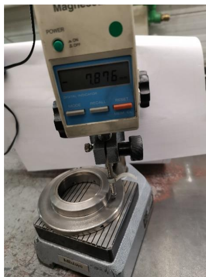
Slika 62: Dimenzijska kontrola visine prstena.
