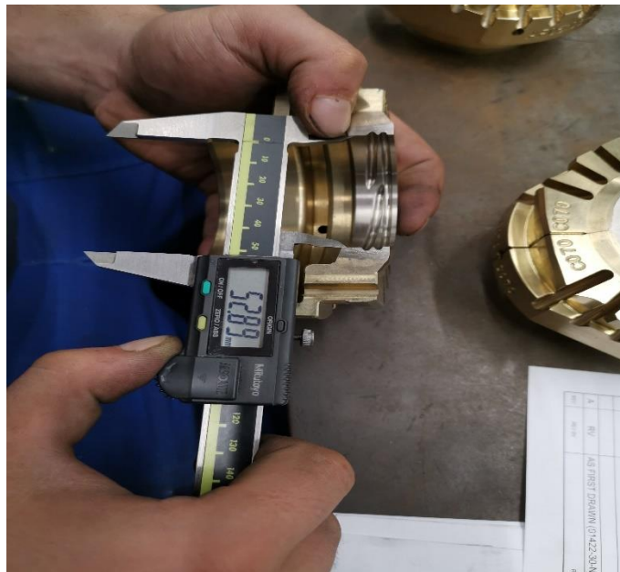
Slika 56: Kontrola promjera fazone pomičnim mikrometrom.
