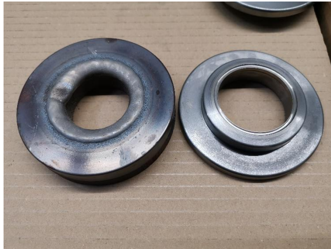
Slika 47: Tokarenje prstena po metalizaciji.
