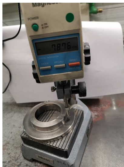
Slika 62: Dimenzijska kontrola visine prstena.
