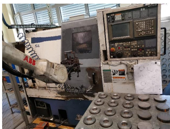
Slika 42: Tokarenje prstena do metalizacije.
