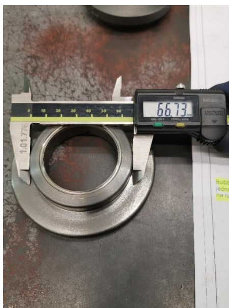
Slika 60: Dimenzijska kontrola vanjskog promjera prstena.
