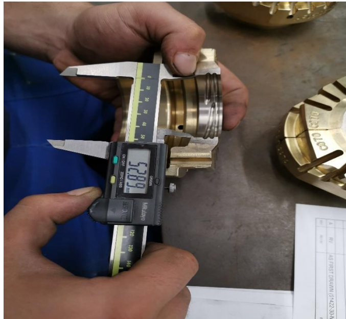
Slika 56: Kontrola promjera fazone pomičnim mikrometrom.
