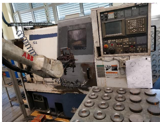
Slika 42: Tokarenje prstena do metalizacije.
