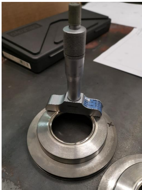
Slika 63: Dimenzijska kontrola dubine fazone prstena.
