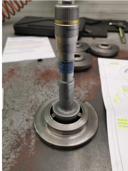
Slika 61: Dimenzijska kontrola unutarnjeg promjera prstena.
