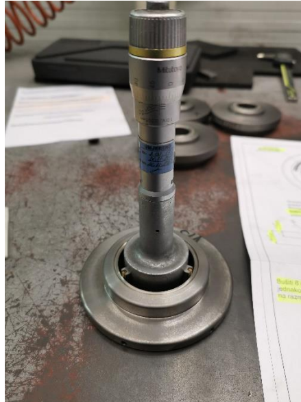
Slika 61: Dimenzijska kontrola unutarnjeg promjera prstena.
