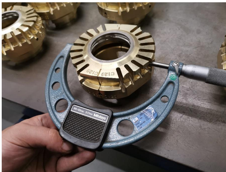
Slika 54: Kontrola promjera prizme na grlu.
