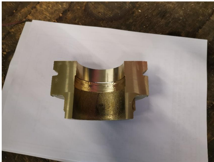
Slika 30: Glodanje prije metalizacije.
