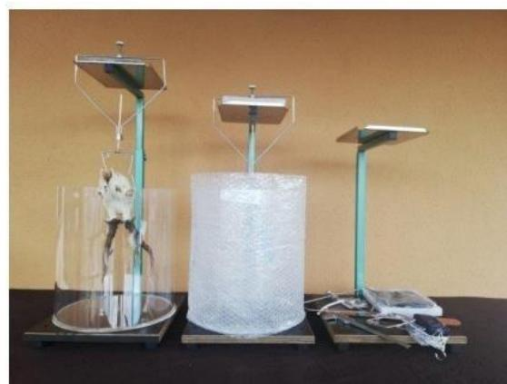
Slika 7: Hidrostatska vaga
