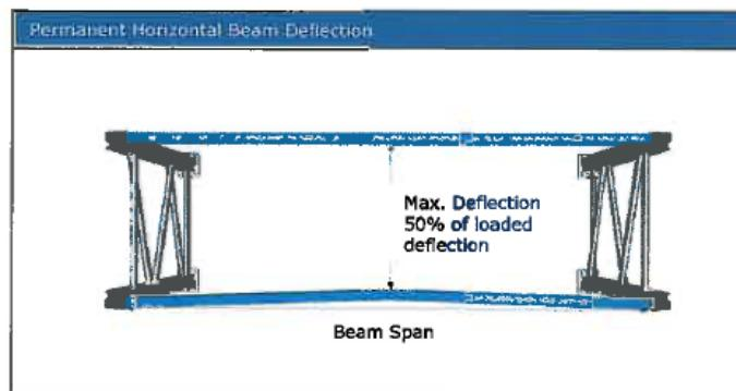
Slika 18. Prikaz preostale bočne deformacije nosača
