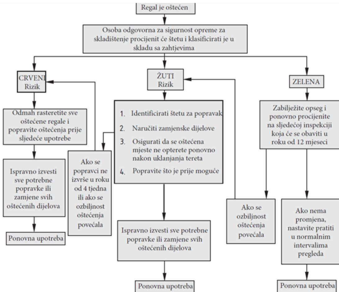
Slika 15. Shema za određivanje oštećenja regala
