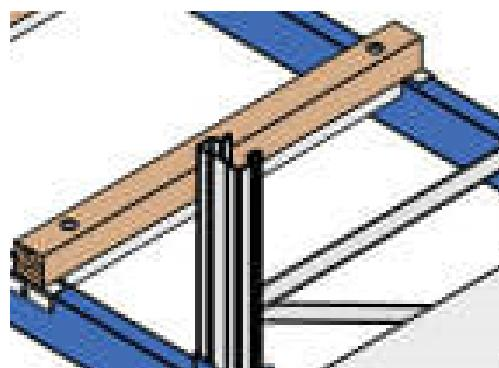
Slika 10. Poprečni nosač paleta
