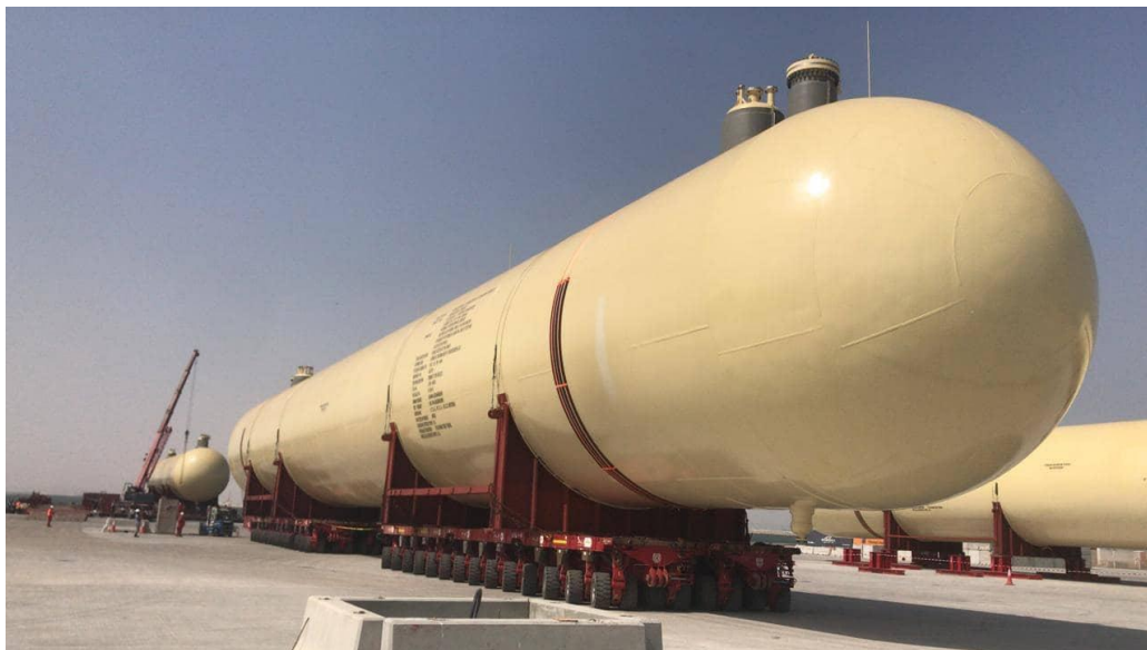
Slika 6. Transport iz luke prema gradilištu pomću SPMT- samohodno modularno vozilo Izvor: https://www.petrofac.com/petrofacts/bullets/
