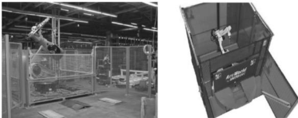
Slika 21. Zaštita radnog područja robota mehaničkom barijerom
