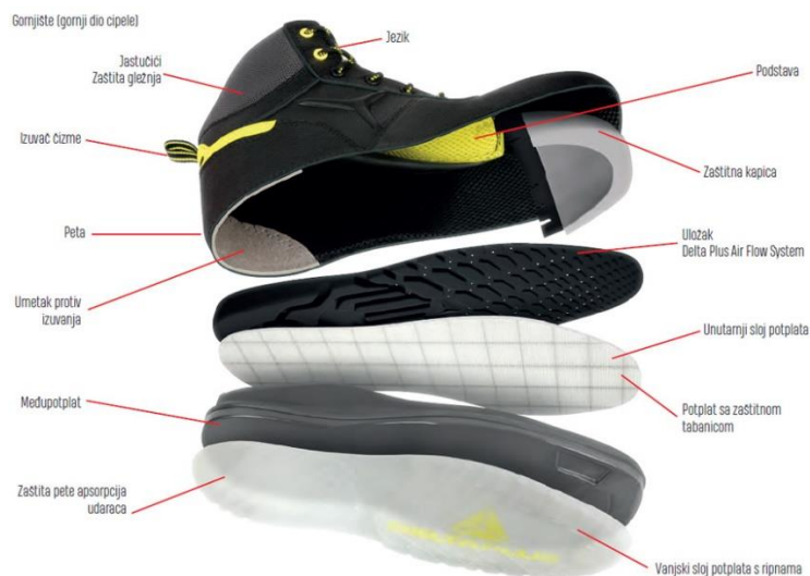
Slika 19. Dijelovi zaštitne cipele s kapicom [10]
