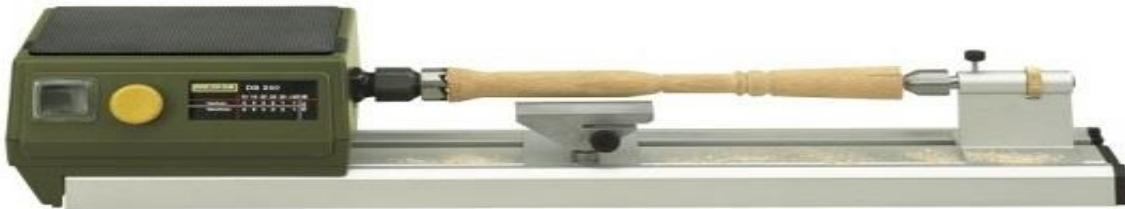
Slika 5. Modelarski tokarski stroj [7]
