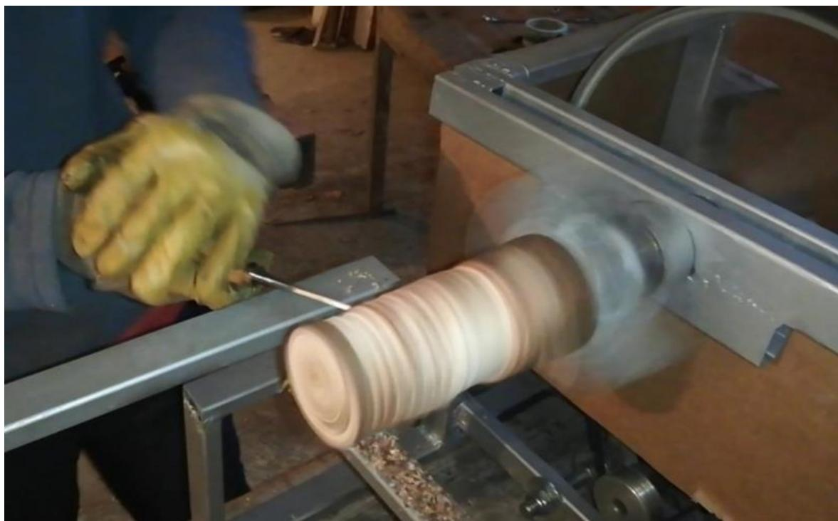
Slika 34. Obrada drva uz pomoću dlijeta
