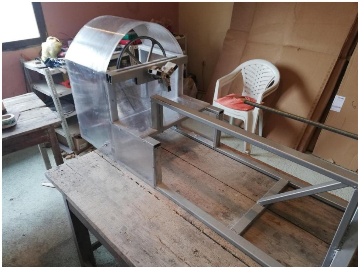
Slika 33. Gotovi tokarski stroj za drvo
