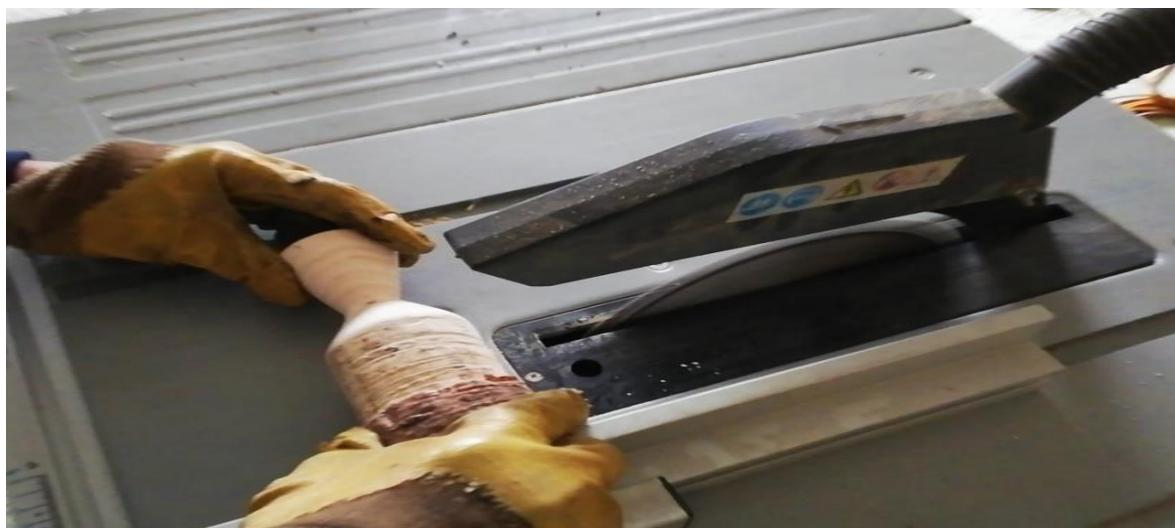
Slika 36. Uklanjanje obradka od viška materijala
