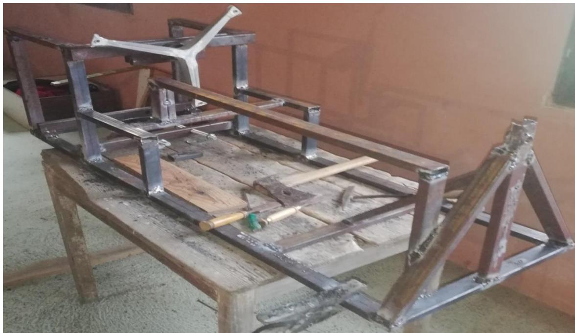
**Slika 30. Zavarena konstrukcija**
