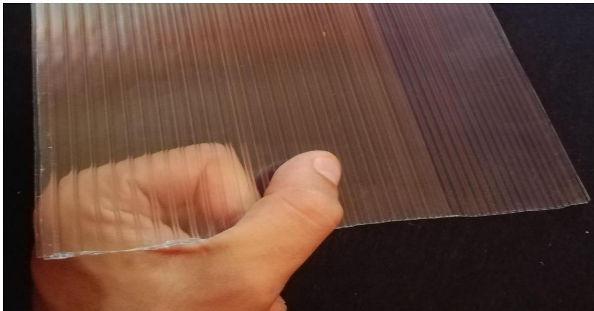
Slika 22. Polikarbonatna lexan ploča
