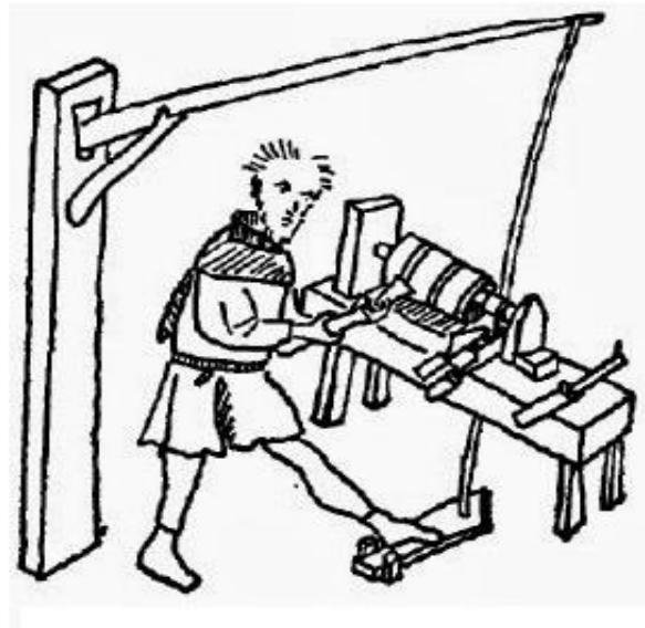
**Slika 2. Tokarilica sa pedalom i savitljivim lukom [3]**
