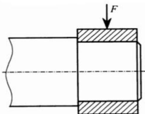
Slika 17. Opterećenje radikalnog ležaja [20]
