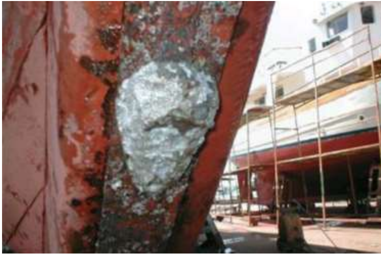
Slika 8. Katodna zaštita žrtvovanom anodom ( www.fsb.unizg.hr/korozija/ )
