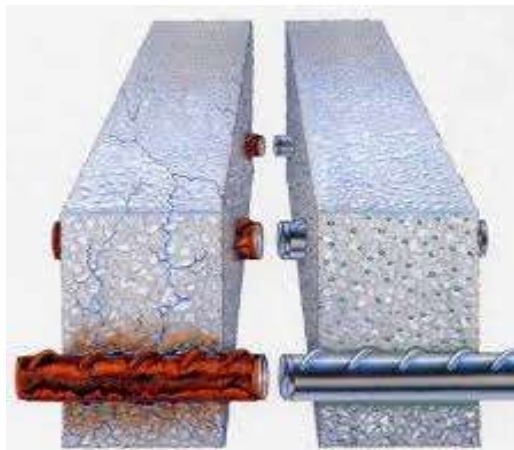
Slika 17. Primjena inhibitora u građevini (Juraga i sur., 2006.)
