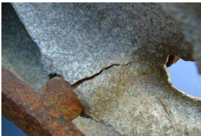
Slika 9. Lom steznog zatvarača (Alar, 2015.)
