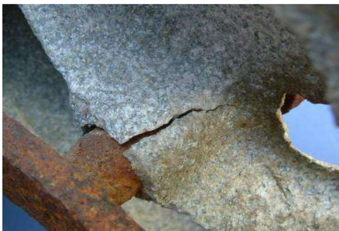
Slika 9. Lom steznog zatvarača (Alar, 2015.)
