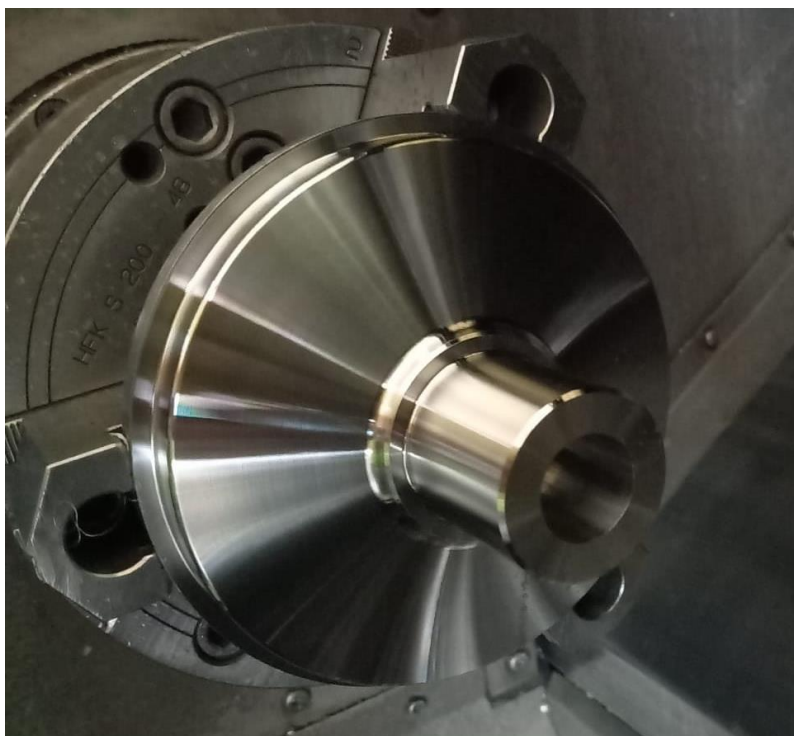
Slika 35. Gotovo tokarenje druge strane
