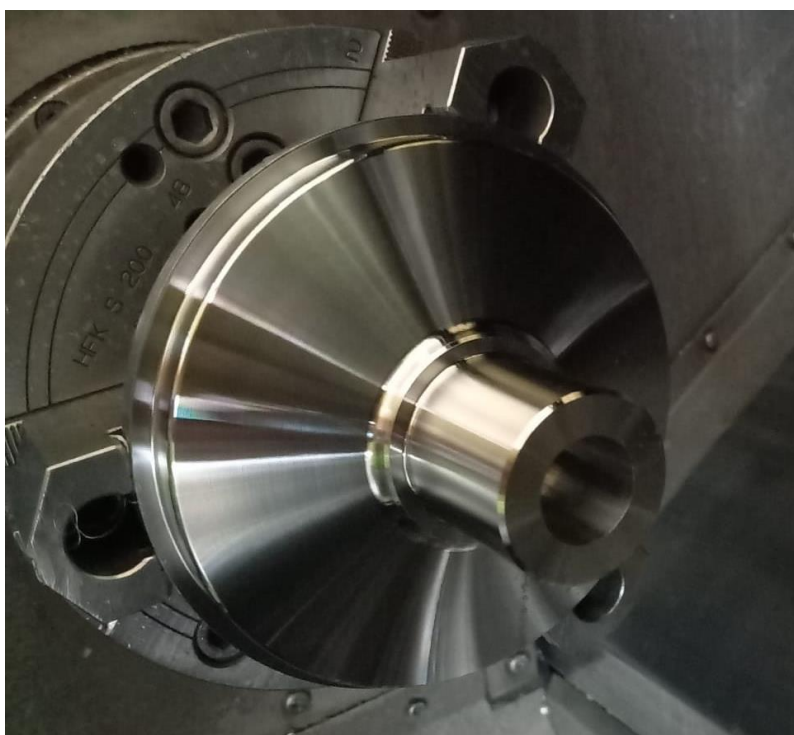
Slika 35. Gotovo tokarenje druge strane
