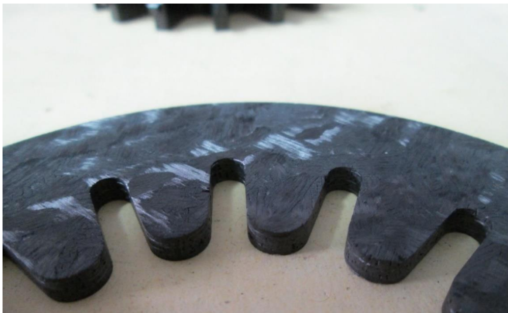
Slika 59. Vizualna kontrola obrađene površine
