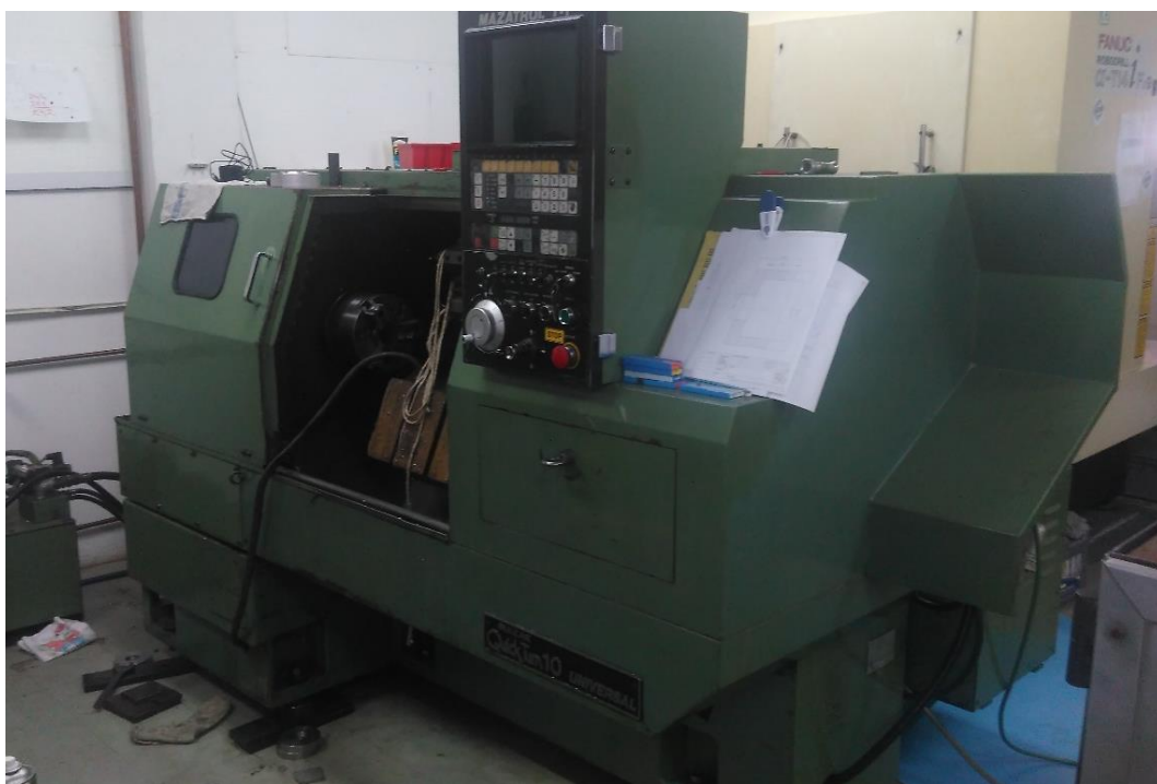
Slika 28. CNC Tokarilica Mazak QuickTurn 10
