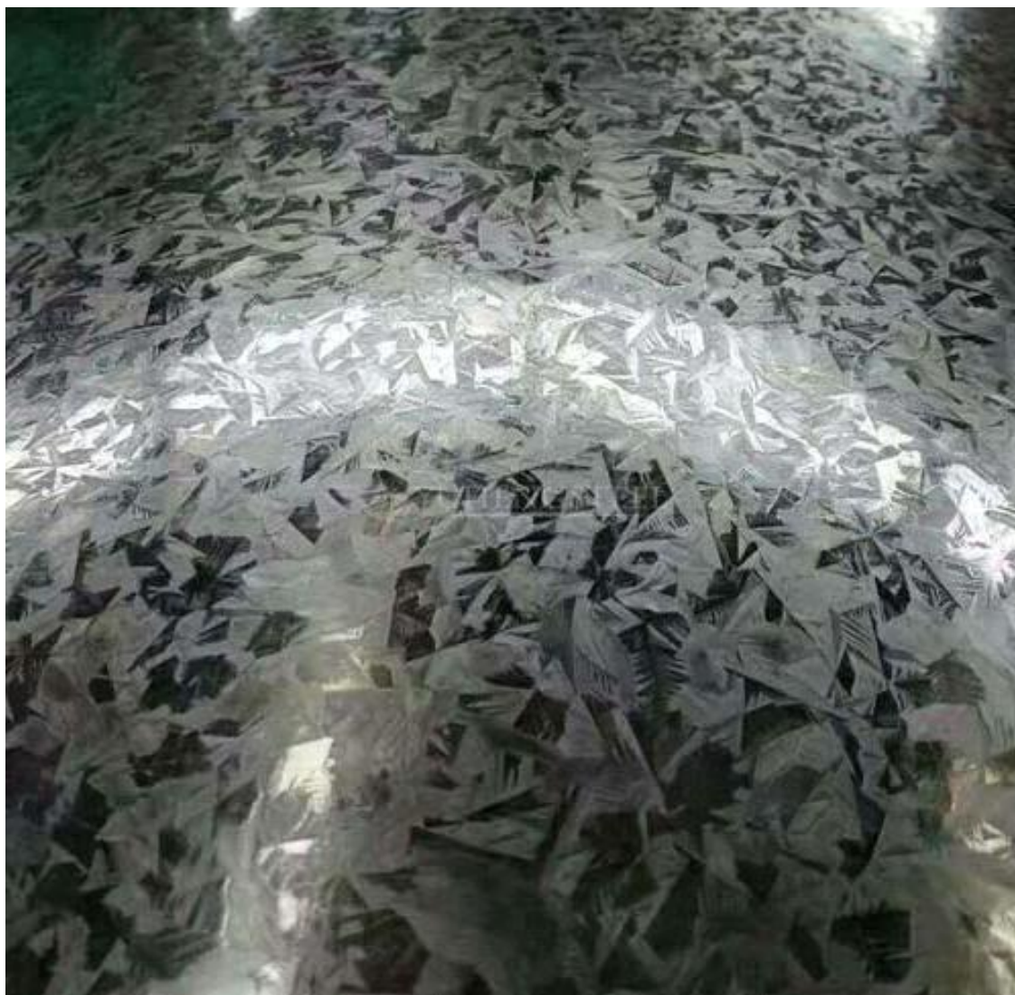
Slika 11. Pocinčani lim s karakterističnim šarama nastalim kristalizacijom legure željeza i cinka u postupku vrućeg cinčanja. [19]
