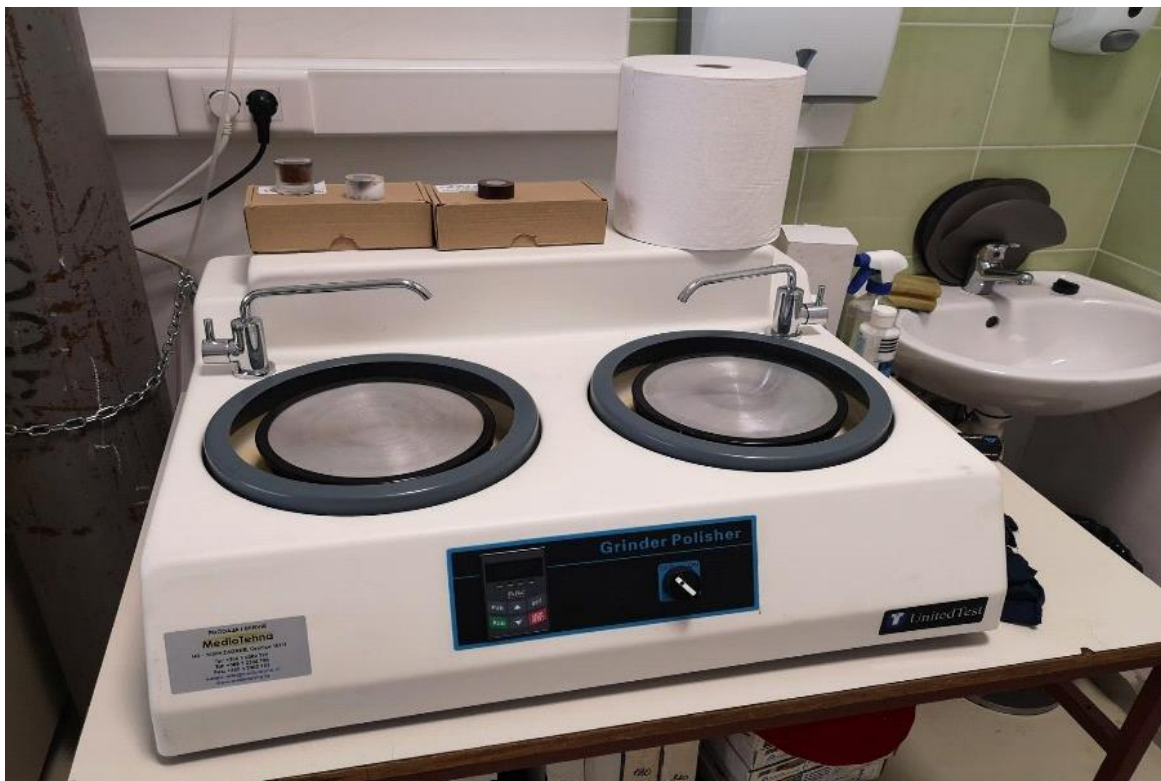
Slika 12. Uređaj za brušenje i poliranje uzoraka MP-2B [25]
