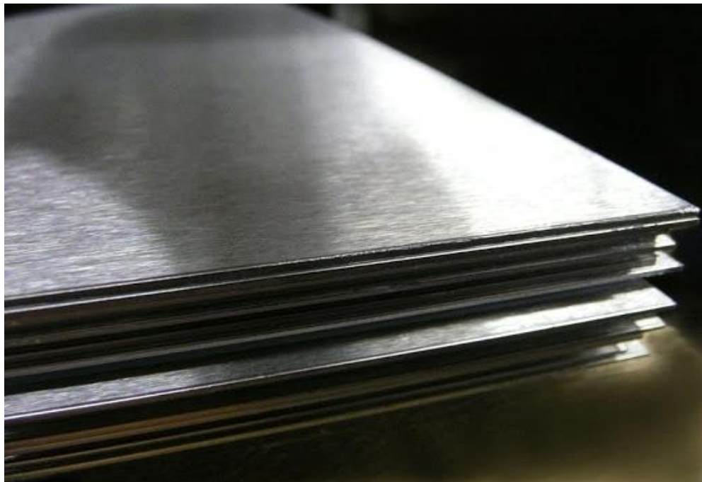
Slika 10. Brušeni inox, AISI 304, debljine 1,5 mm [12]
