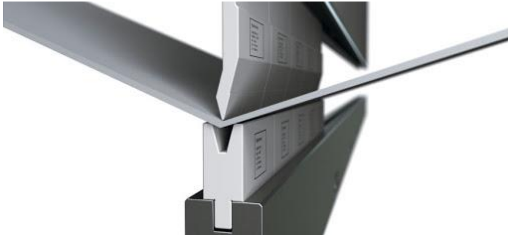
Slika 9: Kutno savijanje lima [9]
