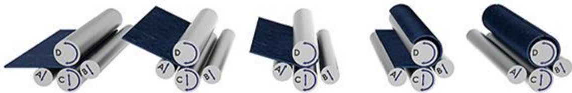
Slika 8: Prikaz rada na savijačici s 4 valjka [15]
