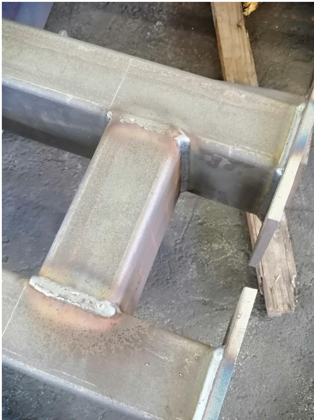
Slika 59. Zavar sklopa kvadratne cijevi i spojne ploče
