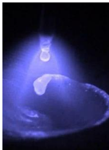
Slika 10. Realni prikaz metala štrcajućim lukom [12]
