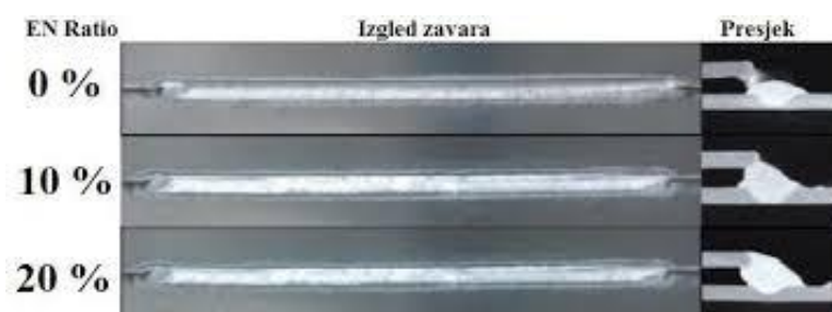
Slika 28. Utjecaj negativnog polariteta pri spajanju aluminijske legure [18]
