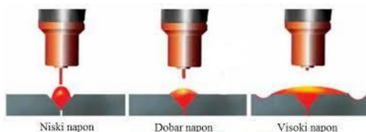
Slika 20. Utjecaj napona na zavareni spoj [18]
