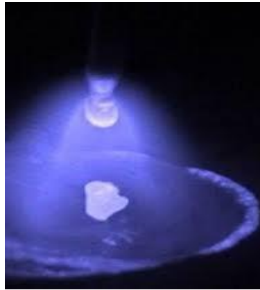
Slika 12. Realni prikaz prijenosa metala mješovitim lukom [12]
