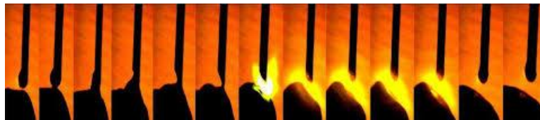
Slika 25. Odvajanje kaplice električnim lukom kod FastROOT postupka [24]
