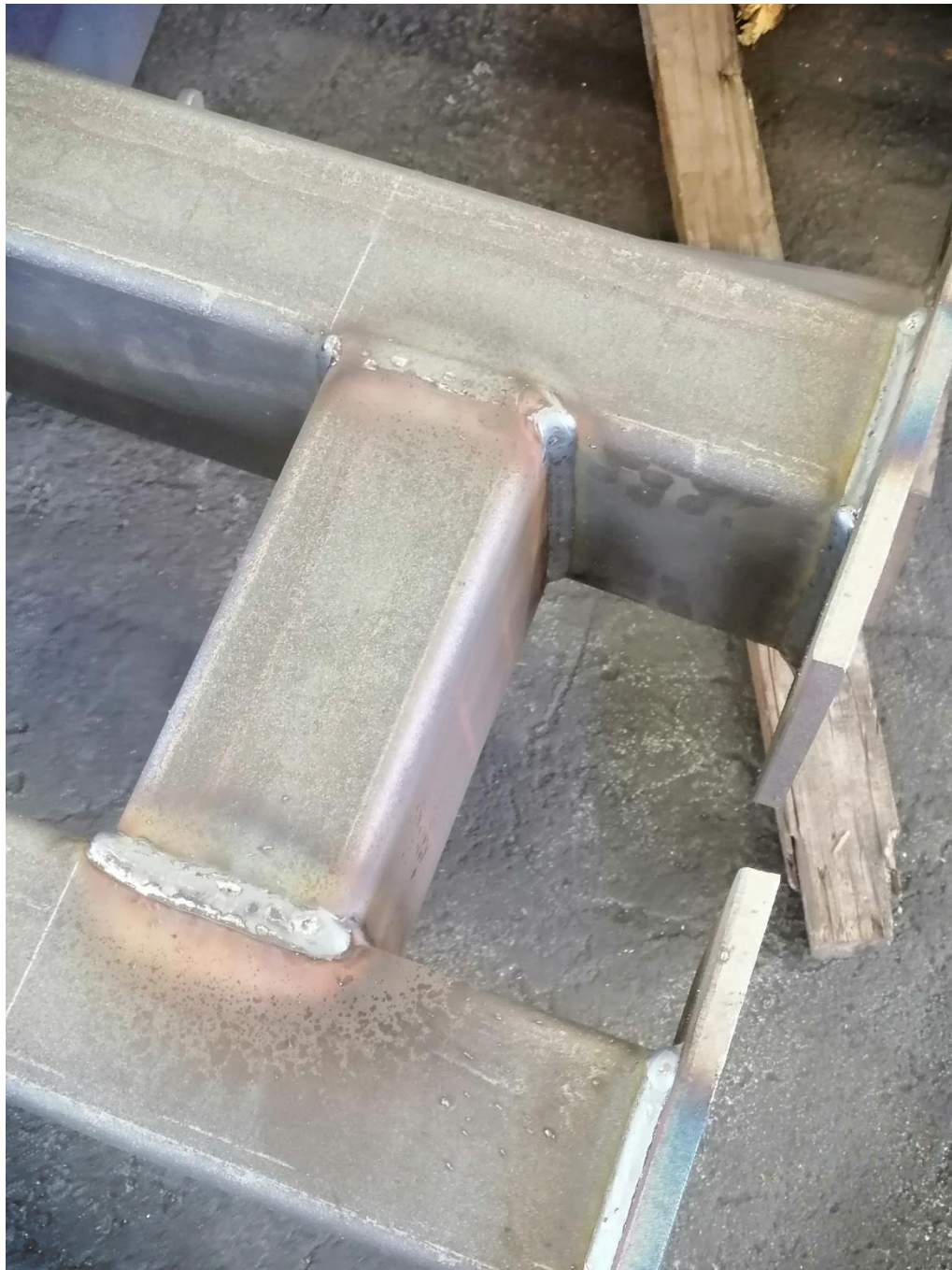
Slika 59. Zavar sklopa kvadratne cijevi i spojne ploče
