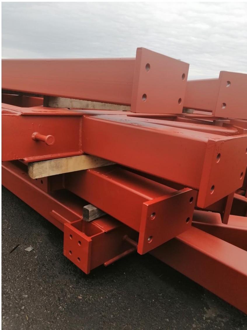
Slika 64. Odloženi sklopovi spremni za transport
