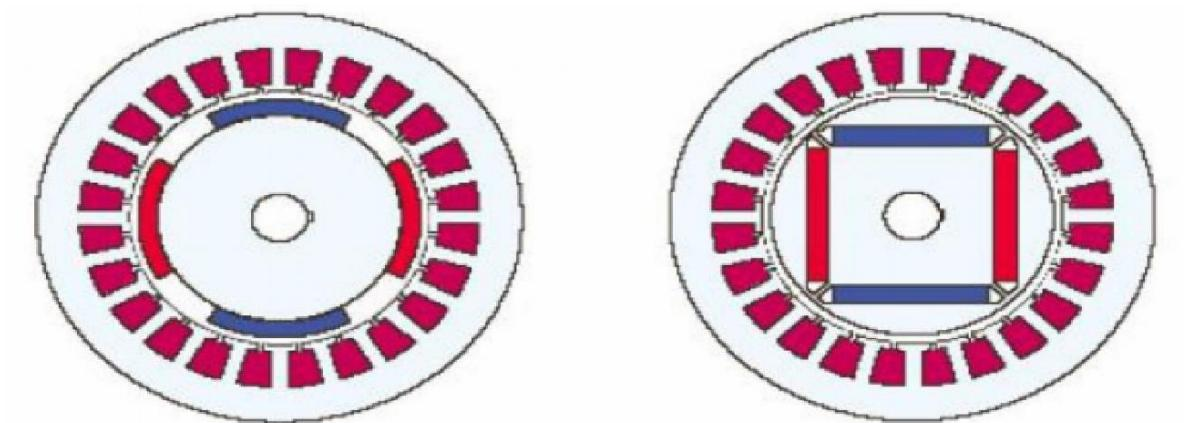
Slika 19. Izvedba DC motora.
