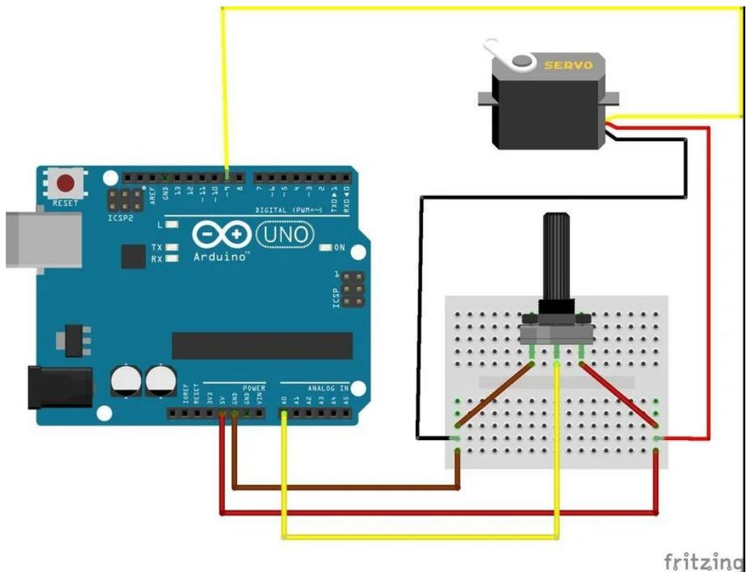
Slika 34. Shema spoja arduina,servo motora i potenciometara.
