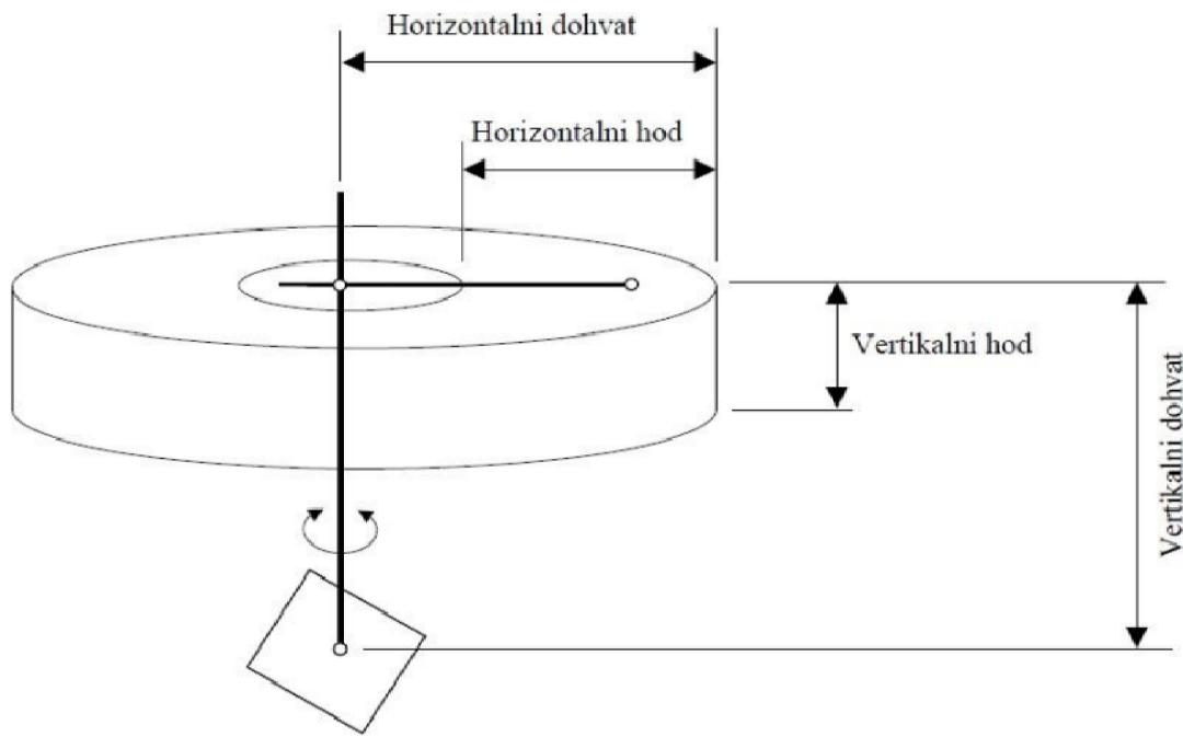
**Slika 10. Dohvat i hod robota cilindrične konfiguracije.**
