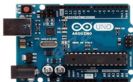
Slika 23. Arduino uno ploča.
