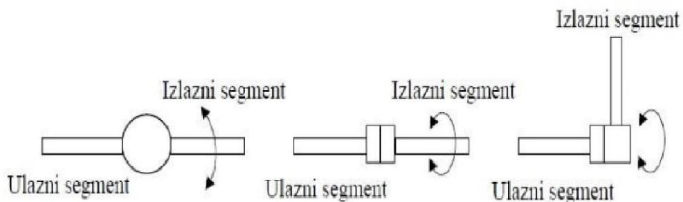
**Slika 6. Rotacijski zglobovi.**
