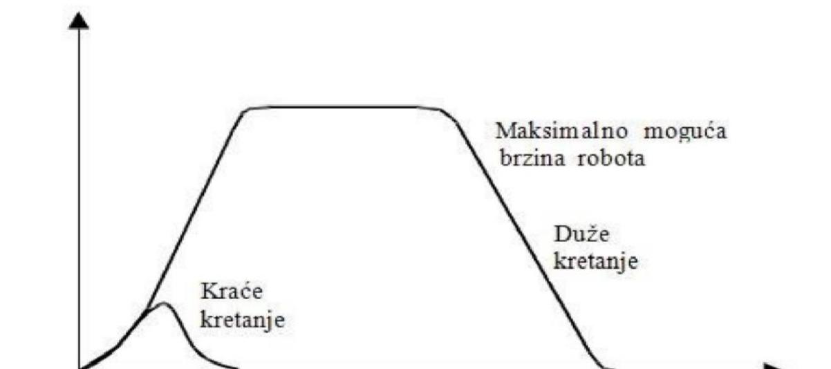
Slika 8. Odnos udaljenosti i brzine kretenja robota.
