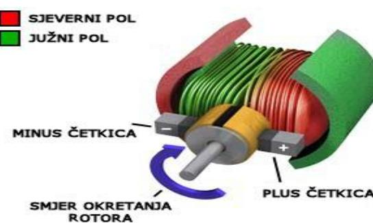
Slika 15. Kolektor ili komutator na rotoru.
