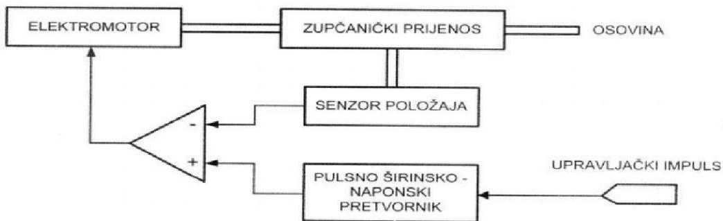
**Slika 17. Blok dijagram sustavnih dijelova servo motora.**
