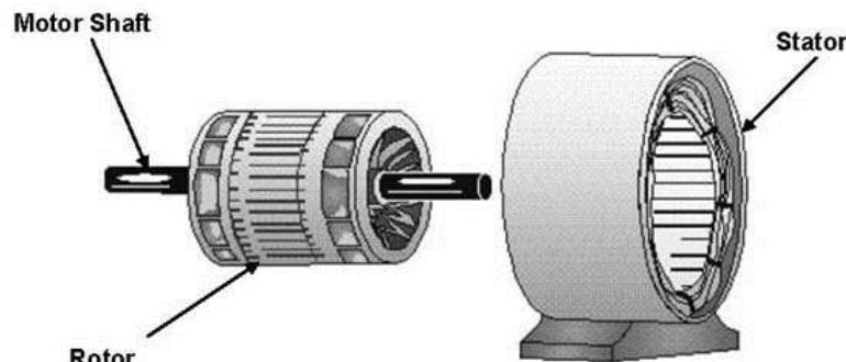
Slika 13,14. Rotor-lijevo, Stator-desno.
