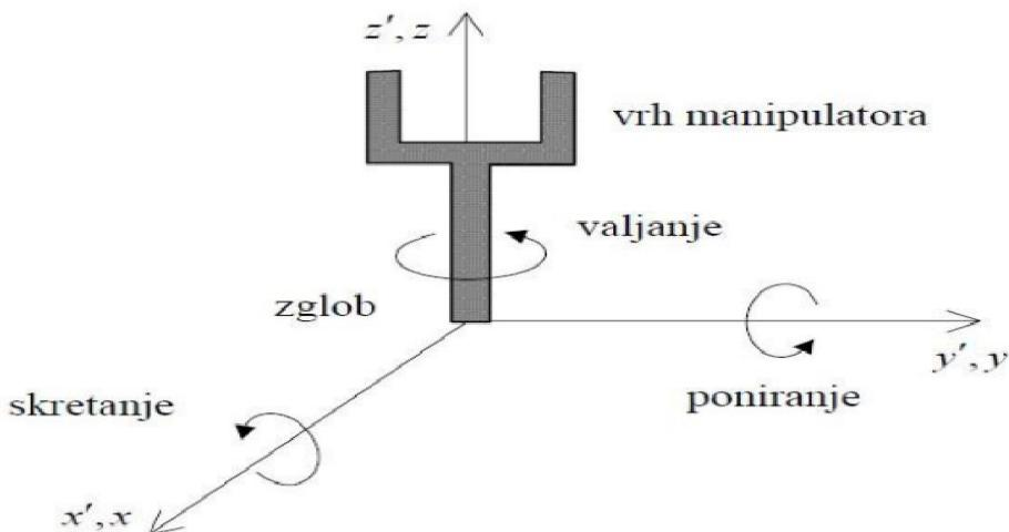
**Slika 11. Skretanje, poniranje i valjanje vrha manipulatora.**
