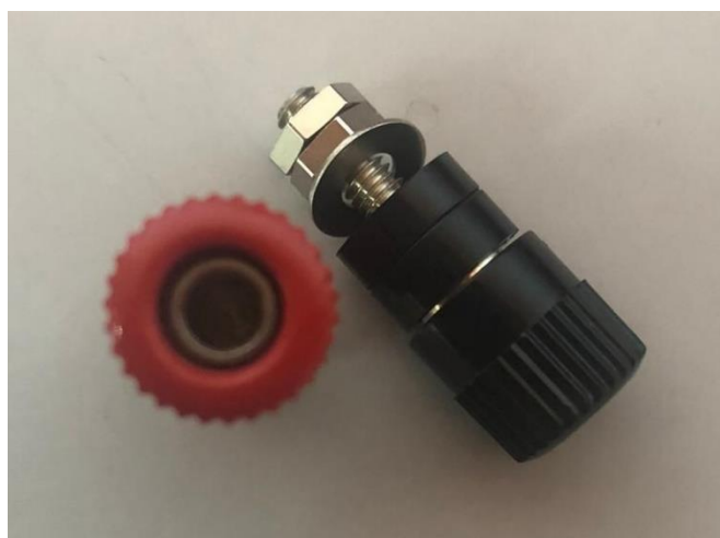
Slika 18. Korištene priključnice 6mm
