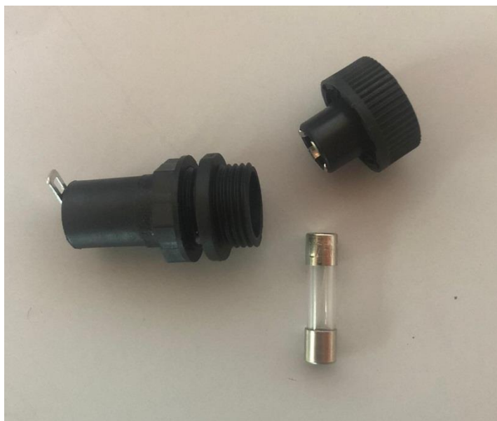
Slika 19. Korišteni fuse 3.15A sa kućištem
