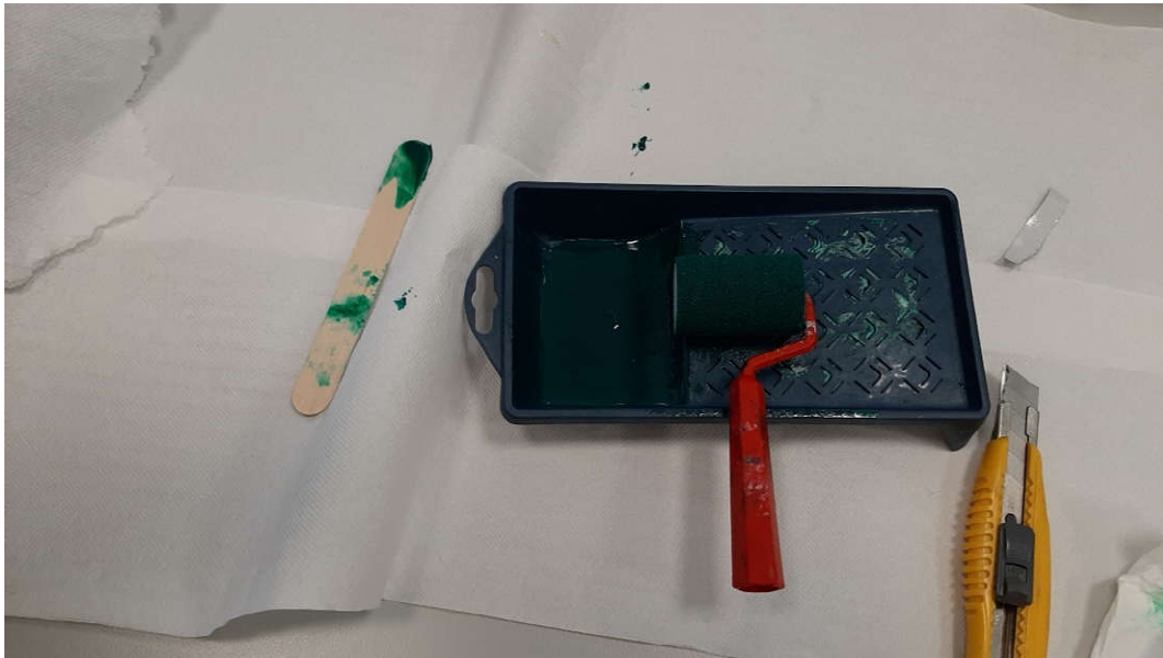
Slika 24. Nanošenje lemne maske Izvor: Autor
