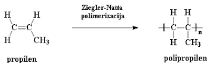
Slika 29. Polimerizacija propilena u polipropilen [31]
