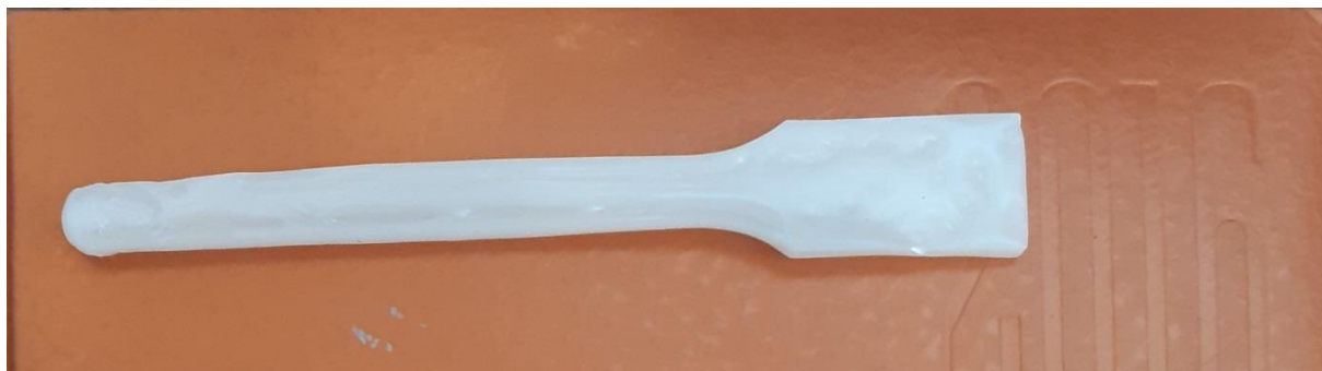
Slika 55. Izgled ispitnog uzorka sa pre niskim indeksom tečenja
