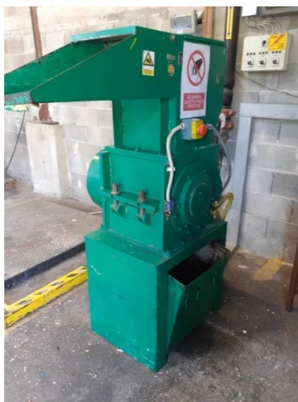
Slika 47. Mlin za usitnjavanje polimernih masa MG – 200
