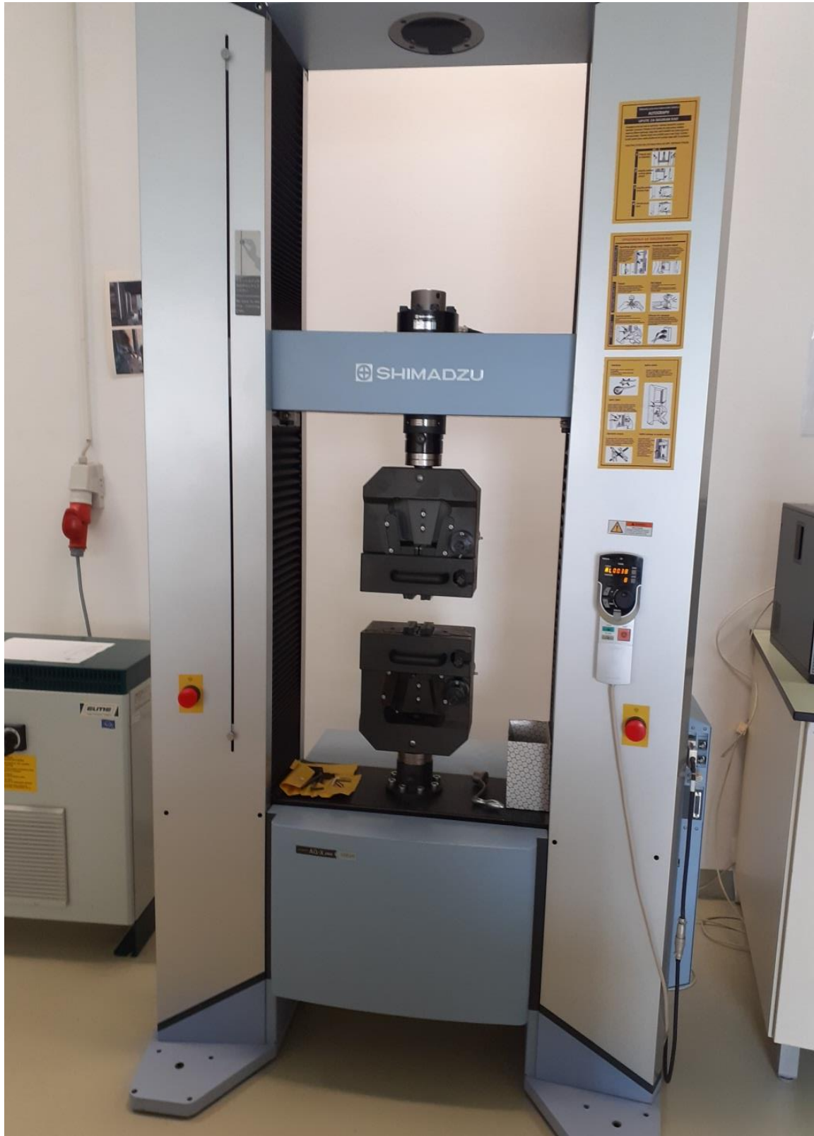
Slika 49. Kidalica Schimadzu AG – X plus
