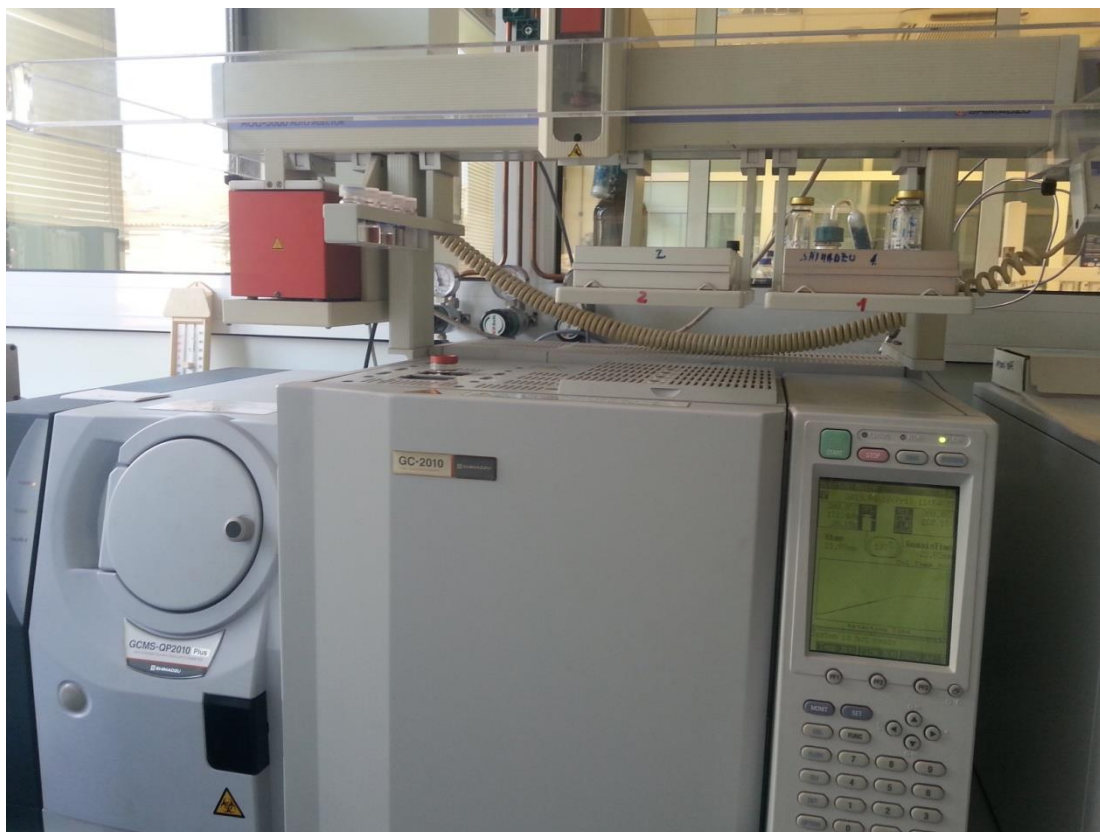
Slika 11: GCMS-qp2010 plus plinski kromatograf i maseni spektrometar
