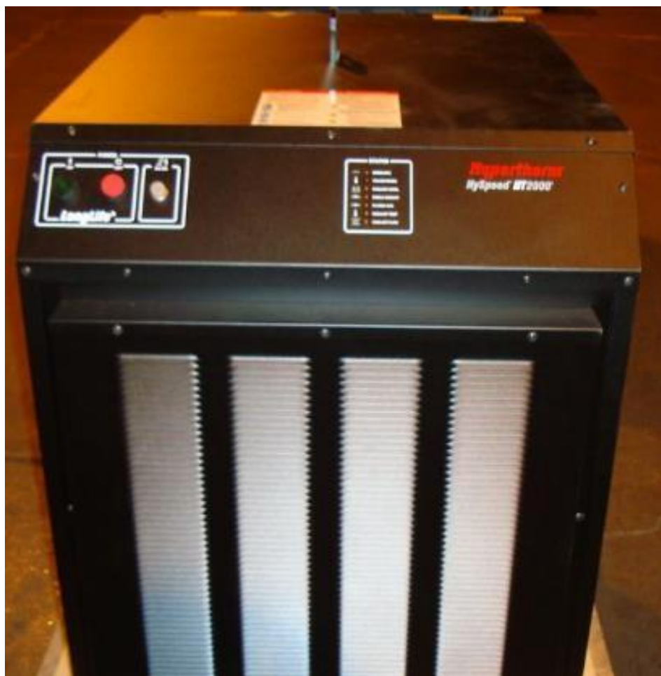
Slika 19. Izvor plazme HT 2000 (Hypertherm)
