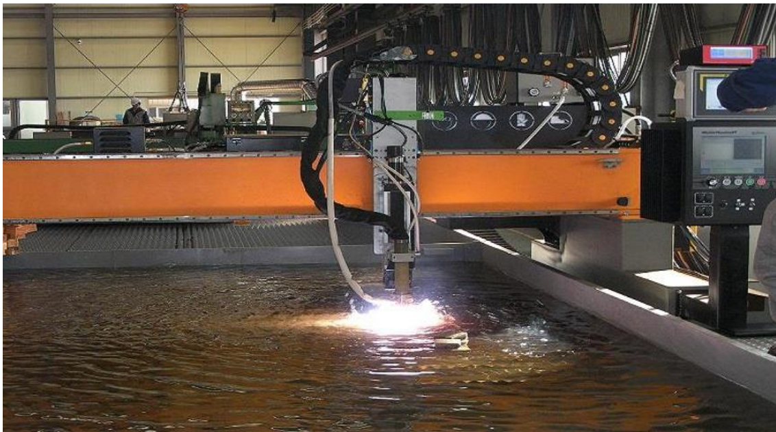
Slika 16. Postupak rezanja plazmenim mlazom pod vodom
