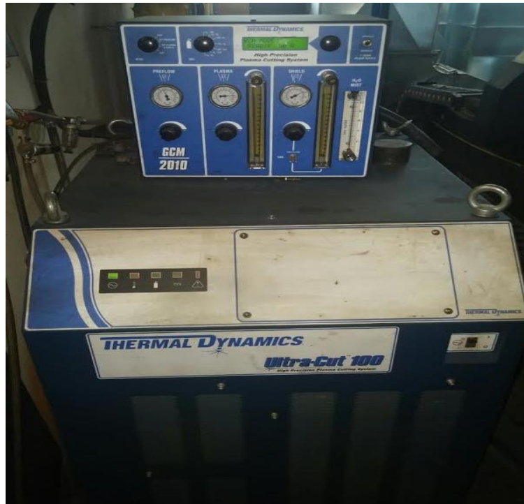
Slika 20. Izvor plazme Thermal Dynamics
