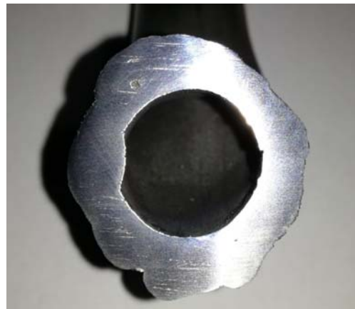
Slika 31. Presjek zavarenog spoja, homogenost osnovnog i dodatnog materijala
