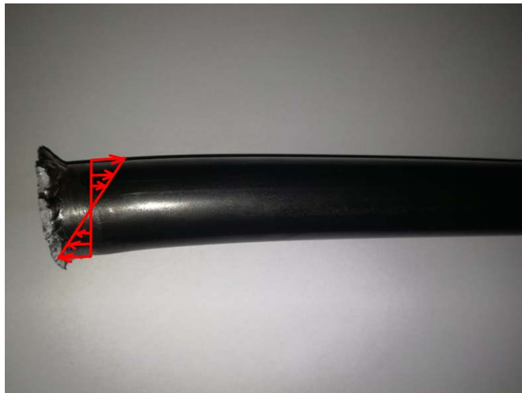
Slika 28. Vlačna i tlačna naprezanja savojno opterećene cijevi
