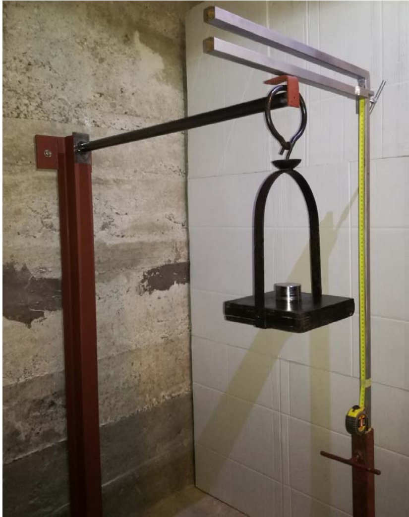
Slika 21. Eksperiment; konzola opterećena silom na kraku
