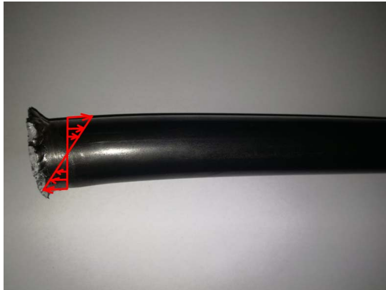
Slika 28. Vlačna i tlačna naprezanja savojno opterećene cijevi
