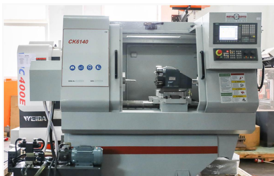
Slika 1.2. Suvremeni CNC tokarski obradni centar [2]
