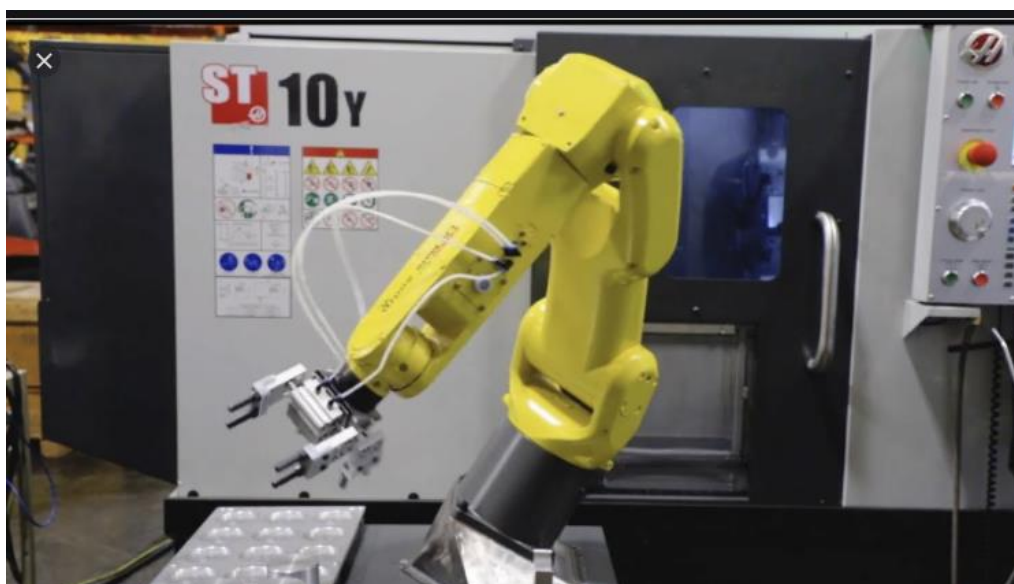
Slika 11. Automatska izmjena obradaka pomoću robota [16]
