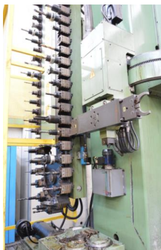
Slika 10. Lančani nosač alata [15]
