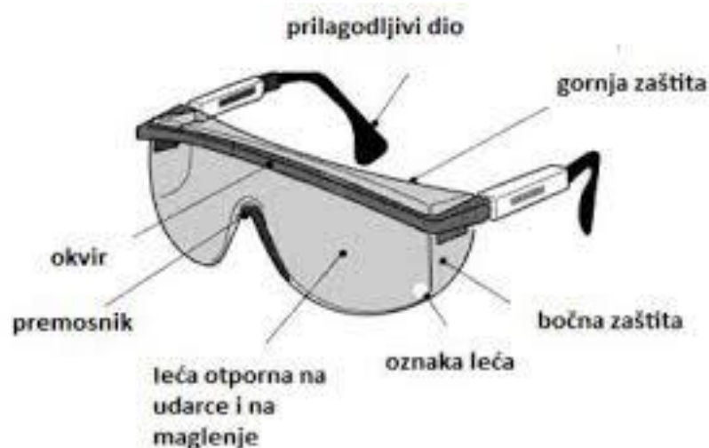
Slika 15. Dijelovi zaštitnih naočala [15]
