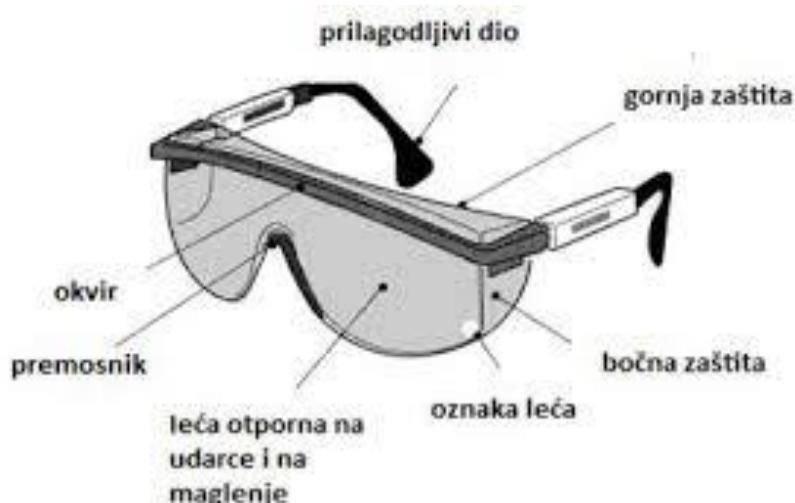
Slika 15. Dijelovi zaštitnih naočala [15]
