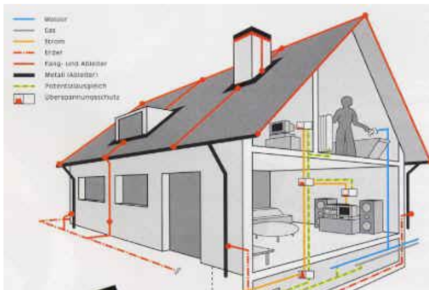
Slika 8. Predodžba vanjski i unutarnji sustav zaštite [20]
