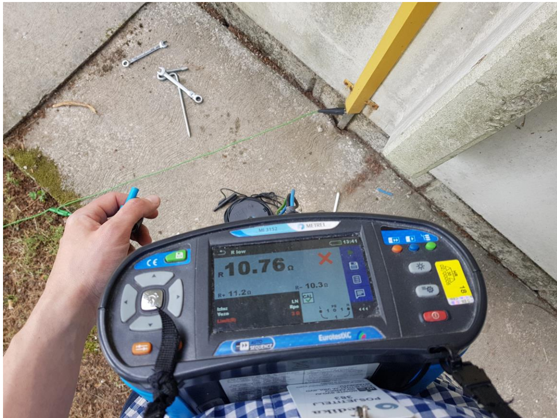
Slika 20. Predodžba ispitivanje otpora uzemljenja [14]
