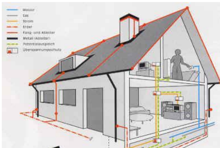
Slika 8. Predodžba vanjski i unutarnji sustav zaštite [20]
