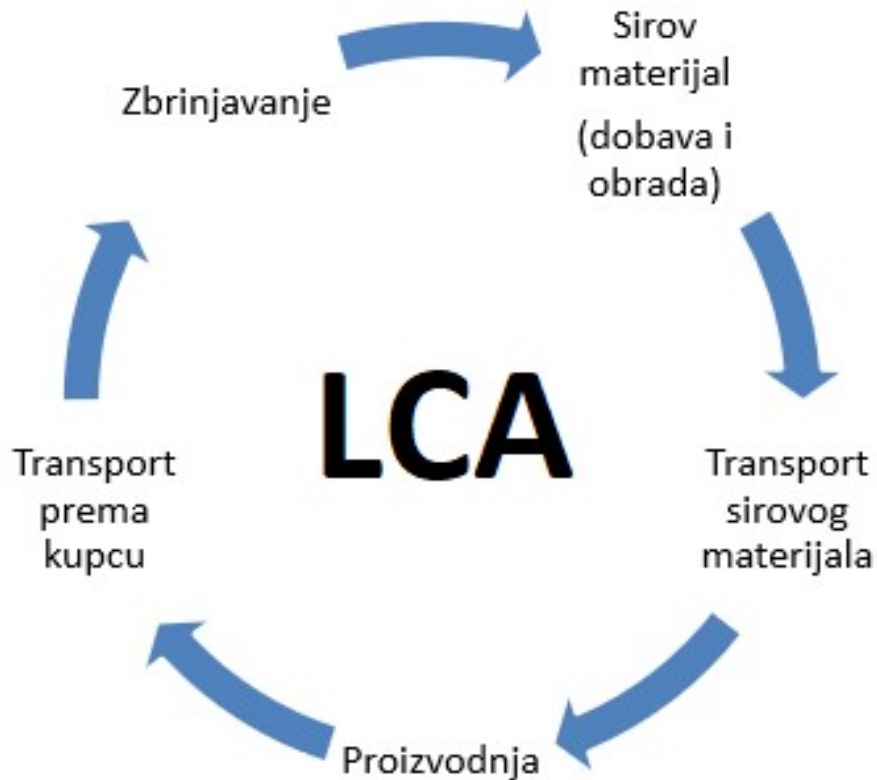
Slika 8. Životni vijek transformatora (LCA)
