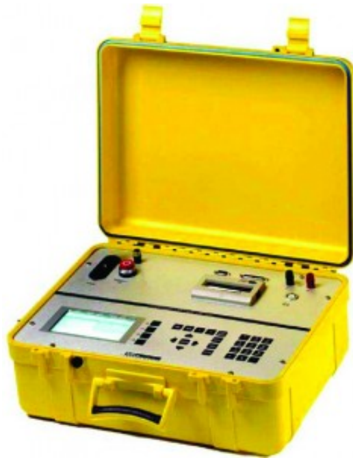
Slika 6. Uređaj za mjerenje napona RVM metodom [14]
