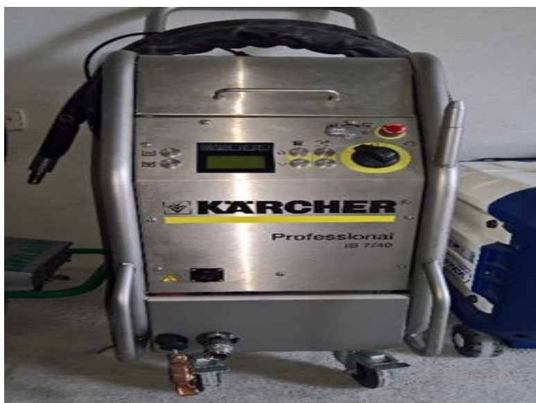
Slika 9. Uređaj za čišćenje suhim ledom
