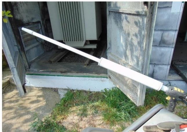
Slika 12. Patentirana motka za čišćenje pod naponom
