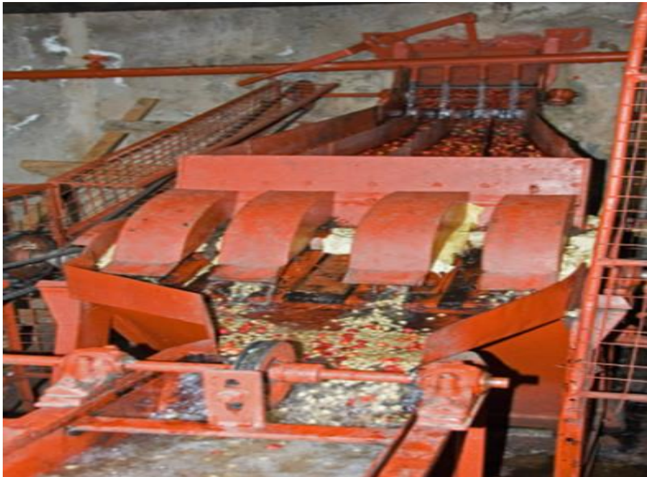
Slika 6. Pulpiranje zrna kave Polumokrim postupkom
