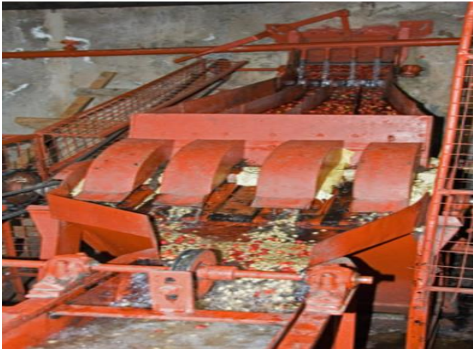
Slika 6. Pulpiranje zrna kave Polumokrim postupkom
