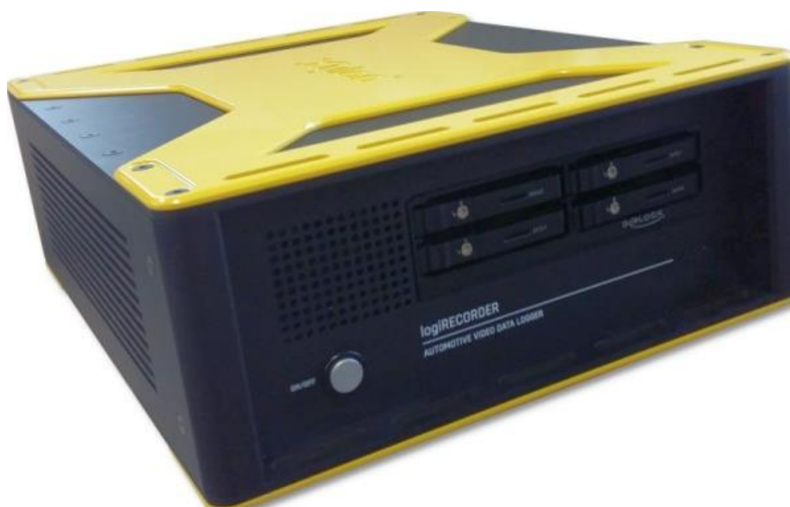
Slika 7: Zapisničar podataka LogiRECORDER
